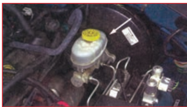
شکل ۱-۷۸- مخزن مایع ترمز و پمپ اصلی
