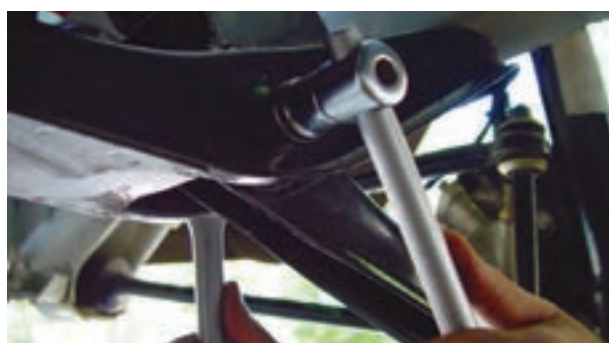
شکل ۳-۸۳ باز کردن طبق از رام
