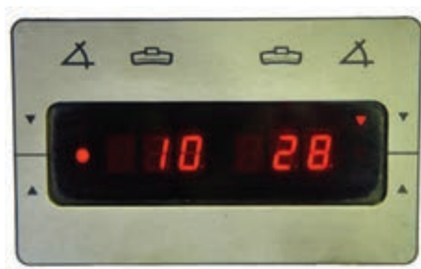
شکل ۲۳۷-۳ تعیین وزنه مورد نیاز در صفحه نشان دهنده
