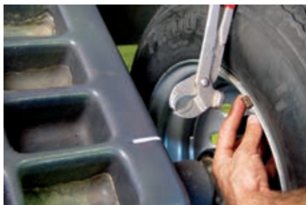
شکل ۲۳۹-۳ نصب وزنه روی قسمت داخلی رینگ
