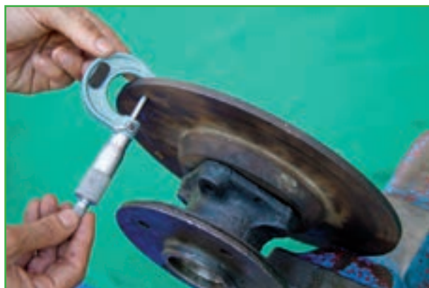
شکل ۱۲۴-۱ اندازه‌گیری ضخامت دیسک
