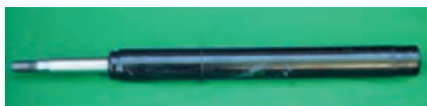
شکل ۳-۹۲ – کمک فنر قابل تعویض
