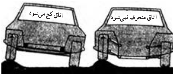
الف- تعلیق مستقل ب- تعلیق یک پارچه
