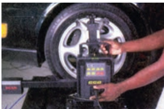
شکل ۳-۲۲۰ - نصب مجموعه حسگر دستگاه اندازه‌گیر رایانه‌ای
