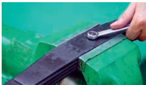
شکل ۳-۶۸- باز کردن پیچ مرکز فنرهای شمش
