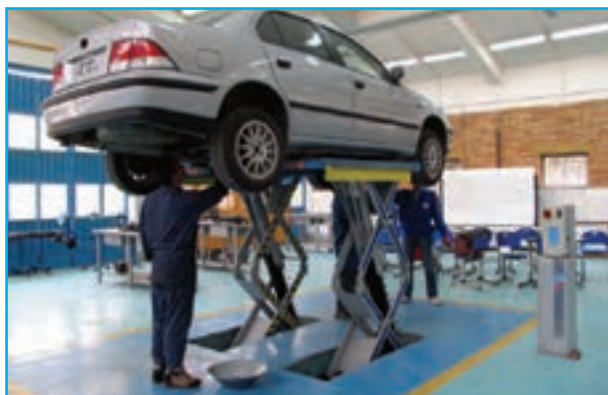
شکل ۴۶-۲- استقرار خودروی روی بالابر
