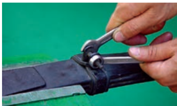
شکل ۳-۶۷- باز کردن بست‌های مجموعه فنر شمش
