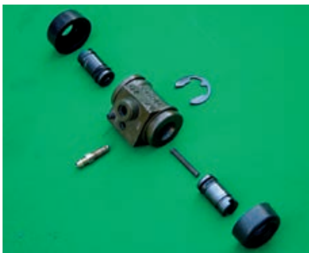
شکل ۹۵-۱- اجزای پمپ ترمز چرخ
