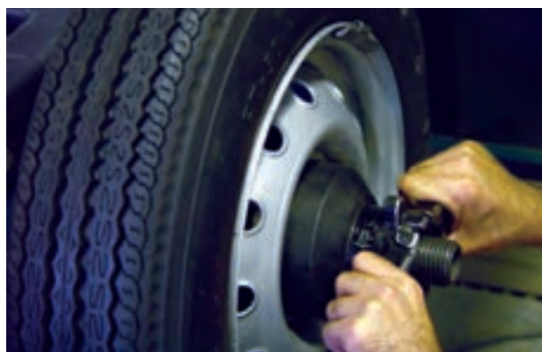
شکل ۲۳۴-۳- نصب چرخ روی دستگاه
