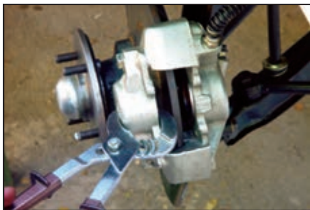
شکل ۱۱۴-۱- عقب راندن پیستون ترمز دیسکی
