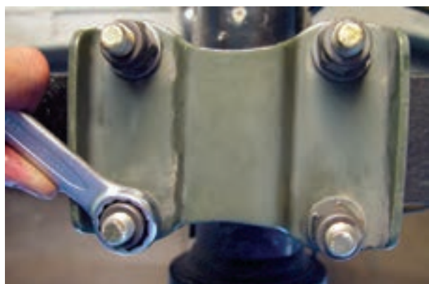
شکل ۳-۶۶- باز کردن مهره‌های کربی‌ها (پیچ‌های U شکل)
