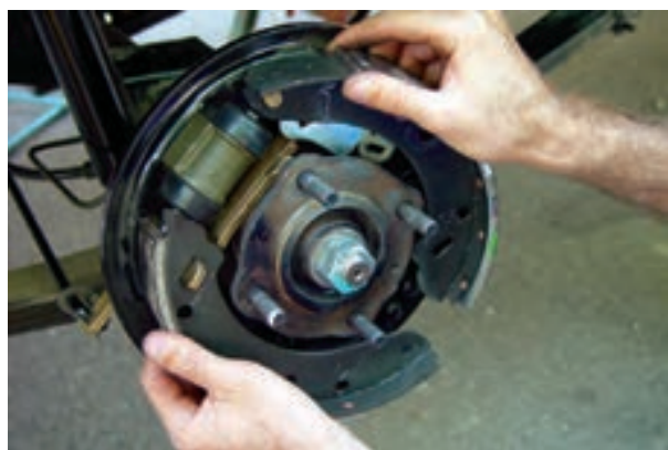
شکل ۱-۱۰۶- نصب کفشک‌ها
