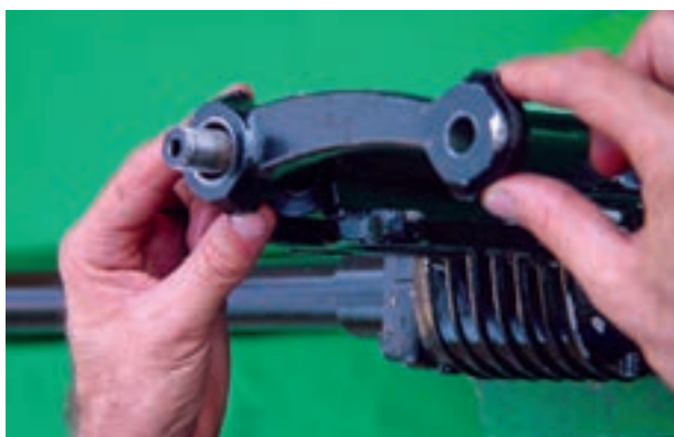
شکل ۵۹-۲- پیاده کردن اهرم هزار خار
