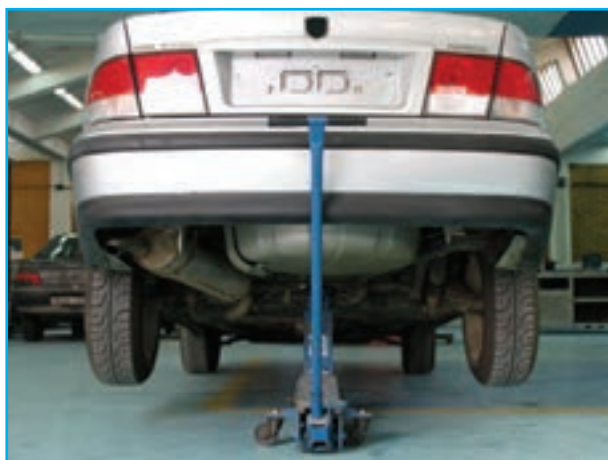
شکل ۳-۱۵۶ تنظیم ارتفاع و کنترل رام لوله‌ای
