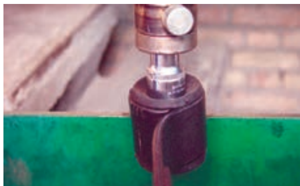
شکل ۳-۶۹- بوش لاستیکی فلزی محل اتصال شاه فنر
