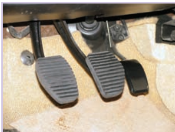
شکل ۱۵-۱- مجموعه پدال‌های ترمز و کلاچ
