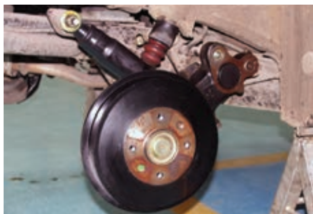
شکل ۱۷۷-۳- نصب کمک فنر
