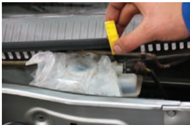
شکل ۱۳۸-۱- مسدود کردن در مخزن مایع ترمز
