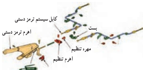
شکل ۱-۴۶- اجزای سیستم ترمز دستی
