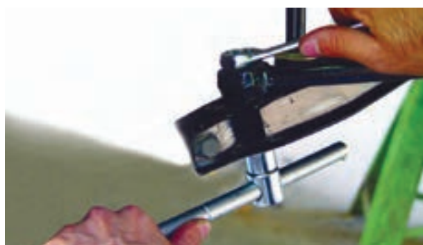
شکل ۳-۸۱ باز کردن میل تعادل از طبق
