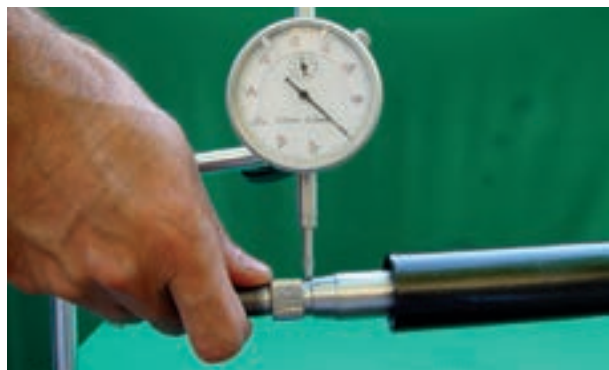
شکل ۶۹-۲ اندازه‌گیری لقی جانبی میل فرمان
