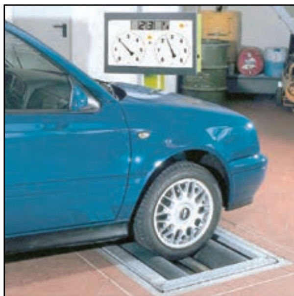
شکل ۱-۷۴ – دستگاه آزمایش دینامیکی ترمز
