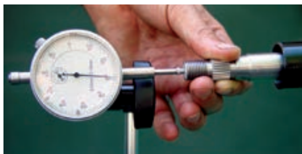
شکل ۶۸-۲ اندازه‌گیری لقی طولی میل فرمان
