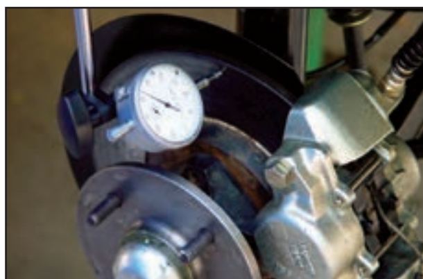
شکل ۱-۱۲۳- بررسی وضعیت دیسک
