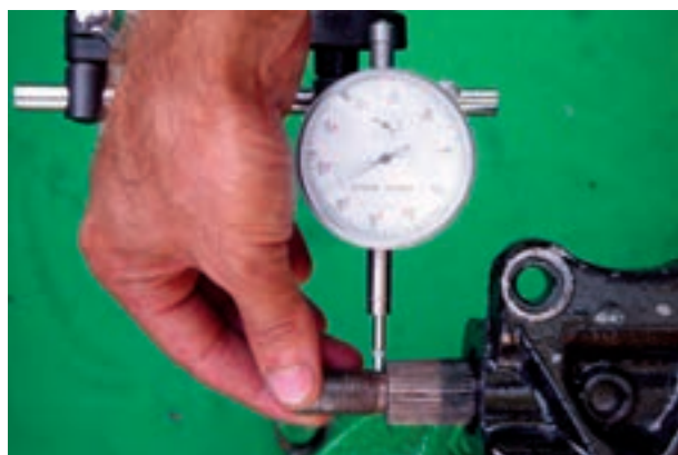
شکل ۷۱-۲ اندازه‌گیری لقی جانبی محور هزار خار
