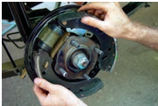
شکل ۹۳-۱- خارج کردن کفشک‌ها
