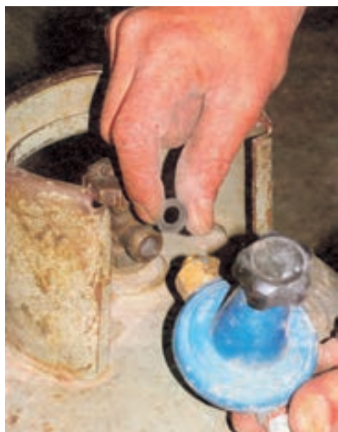
شکل ۱-۶۲ ب رگولاتور قابل تنظیم
