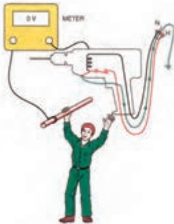
شکل ۴-۲۶ دستگاه دریل دارای سیم ارت
