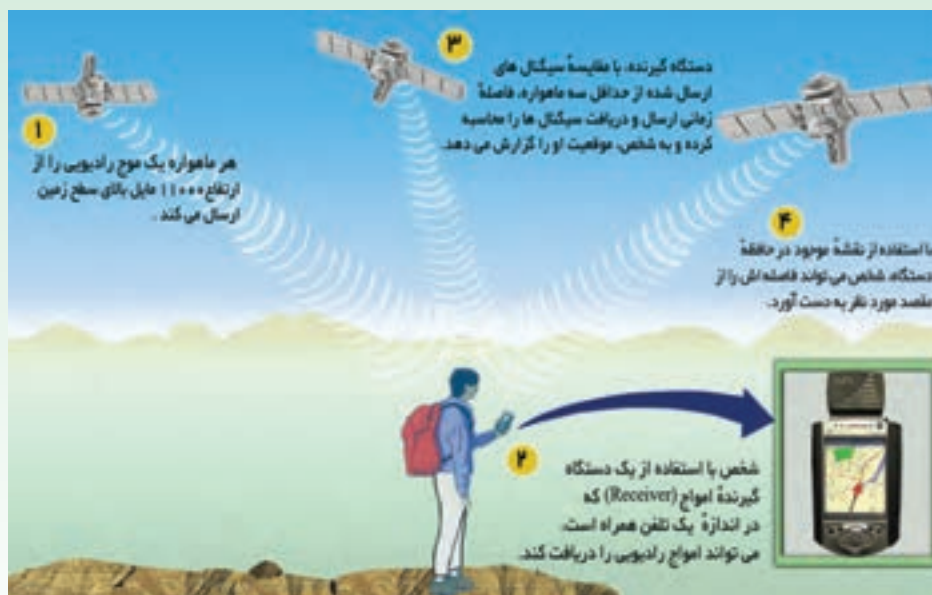
شکل ۵-۵- راه‌یابی با کمک GPS
