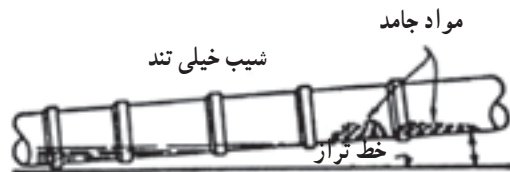
شکل ۱۱-۳ الف - نتیجه‌ی شیب زیاد لوله‌ی افقی فاضلاب
