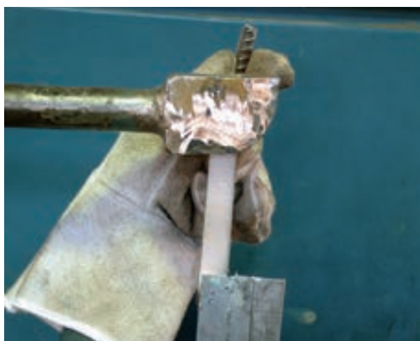
شکل ۱۲۹-۲- نحوه‌ی بستن قطعه به گیره
