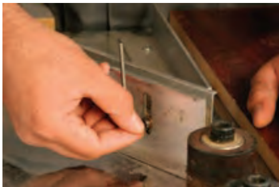
شکل ۱۳۲-۱۶- تنظیم کانال گرم‌کن نوار برای عرض لازم.
