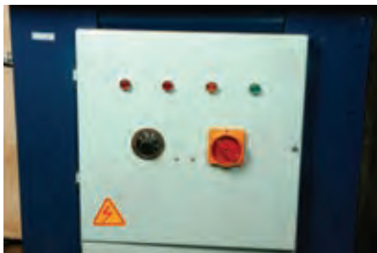
شکل ۱۶-۱۲۶- کلید روشن کردن هیتر و کلید تنظیم حرارت و چراغ‌های هشدار دهنده.
