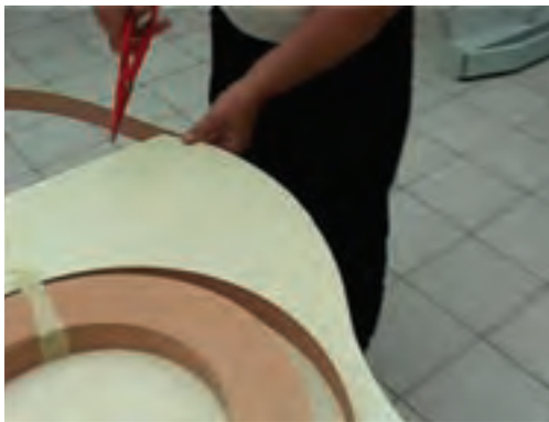
شکل ۱۰۳-۱۶- قطع کردن نوار لبه‌چسبان با قیچی.
