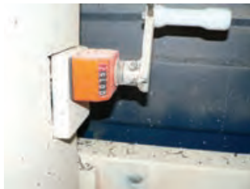
شکل ۱۸۳-۱۶. نمراتور تنظیم فاصله قسمت فوقانی.
