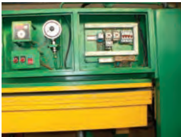
شکل ۴۴-۱۵. گیج‌های مرارتی و فشار در ارتباط با فیزهای اتومات.
