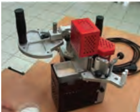
شکل ۹۹-۱۶- مخزن چسب گرانول و پیچ تنظیم چسب.
