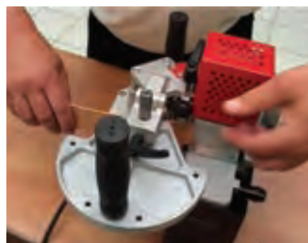
شکل ۱۰۵-۱۶- عبور نوار لبه چسبان آزمایشی.
