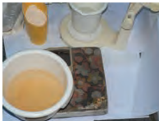
شکل ۵۸-۱۵- وزن کردن مواد چسب بوسیله ترازو.
