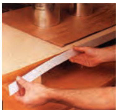
شکل ۱۶-۶۵- استقرار دقیق نوار لبه چسبان (روی چسب).
