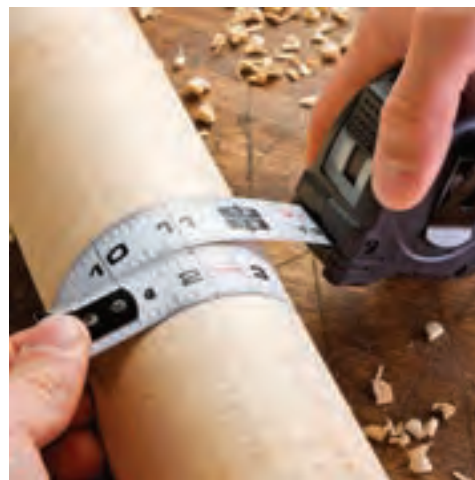
شکل ۶-۸. اندازه‌گیری محیط استوانه با متر پلاستیکی.
