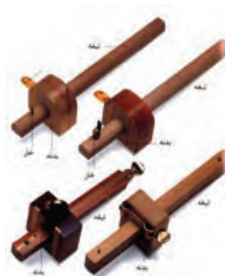
شکل ۷-۹ چهار نوع خط کش تیره‌دار چوبی.
