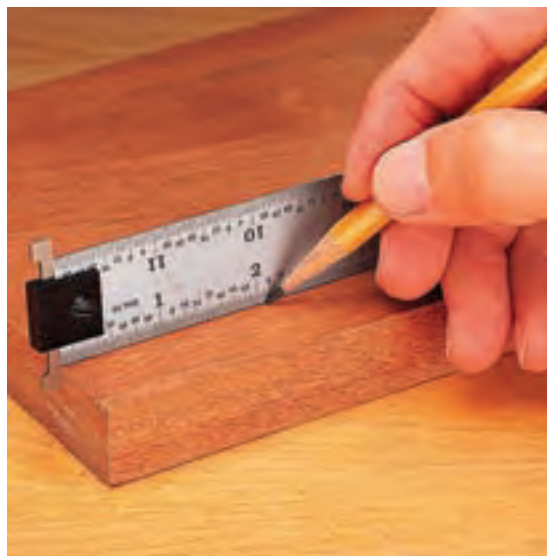
شکل ۵۵-۱۶. فمکشی روی روکش طبیعی با مداد و فمکشی.
