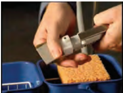
شکل ۸۸-۱۵. شستشوی تیغه چسب‌زن دستی پنوماتیک.
