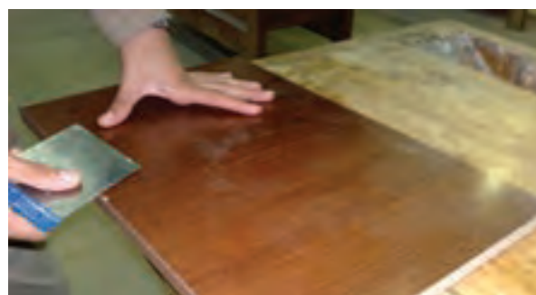
شکل ۱۴۱-۱۶. برداشتن اضافه نوار با لیسه.
