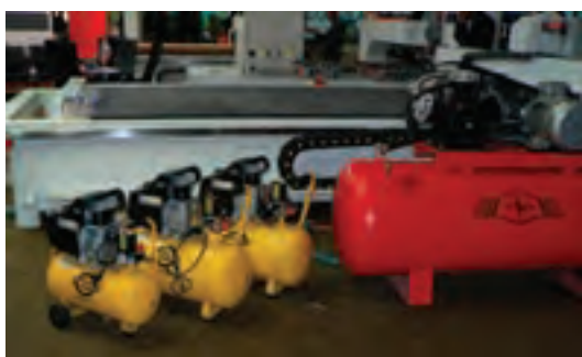
شکل ۱۴۷-۱۶- ایجاد هوای فشرده با کمپرسور.
