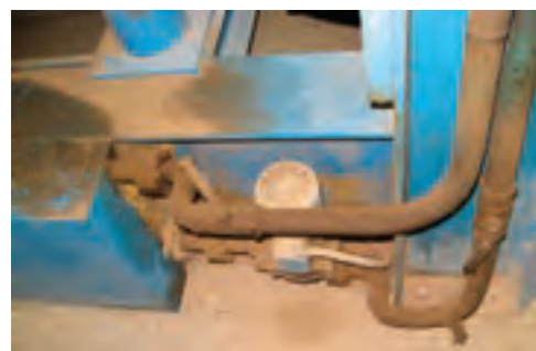
شکل ۱۸۲-۱۵- اهرم برگشت روغن در پرس روغنی.
