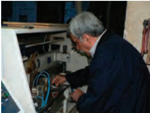
شکل ۱۶۱-۱۶- باز کردن در مخزن چسب و ریختن گرانول داخل آن.
