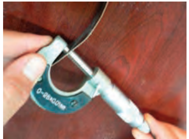
شکل ۳-۸. میکرومتر با میدان اندازه‌گیری (۰ - ۲۵) میلی‌متر.
