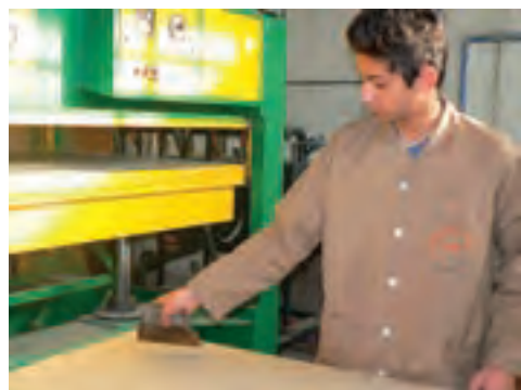
شکل ۷۹-۱۵. کاردک شانه‌ای را ۴۵ درجه در دست بگیرید.
