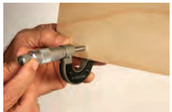
شکل ۱۶۰-۱۶- اندازه‌گیری ضخامت (روکش با میکرومتر).
