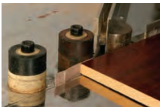
شکل ۱۳۷-۱۶- لبه اضافه نوار در شیار سطح صفحه میز ماشین.
