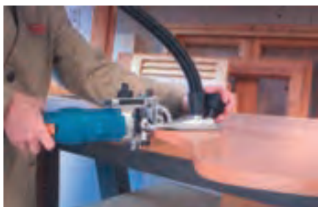
شکل ۸۶-۱۶- پرداخت لبه قوسی به صورت افقی.
