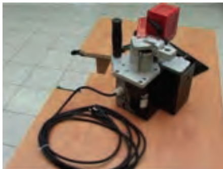
شکل ۹۵-۱۶- دستگاه لبه چسبان و میز کار مناسب.
