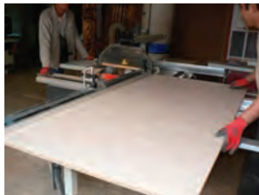
شکل ۱۴۵-۱۶- برش M.D.F در کارگاه لبه چسبانی.
