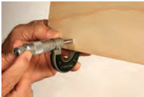
شکل ۱۶۵-۱۵- اندازه‌گیری ضخامت روکش با میکرومتر.
