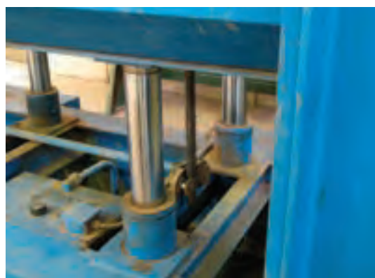
شکل ۳۳-۱۵- حرکت همزمان و متعادل سیلندرها توسط چرخ دنده پرس.
