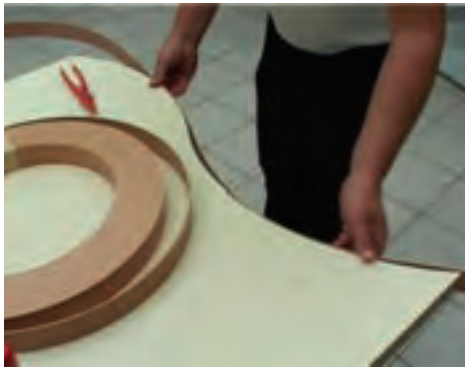
شکل ۱۰۲-۱۶- اندازه‌گیری نوار لبه‌چسبان.
