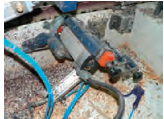
شکل ۱۷۴-۱۶- تنظیم تویی فرز پرداخت لبه نوار.
