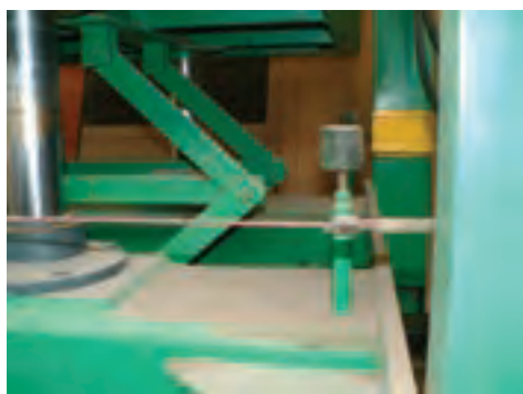
شکل ۱۴۵-۱۵. اهرم‌ها با توپی لاستیکی مقر صفحه پرس.
