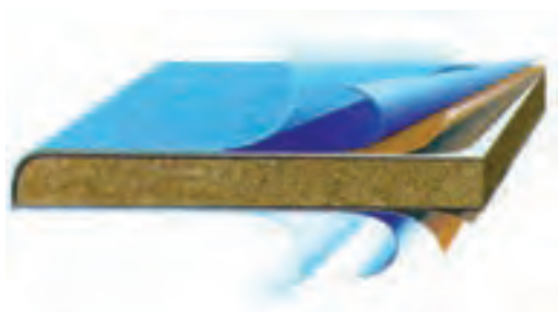
شکل ۷-۴. مقاوم کردن تخته فیبر با ورقه‌های H.P.L - PVC لترون و غیره جهت مصارف خاص.
