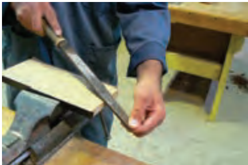
شکل ۱۹۹-۱۵- قطع کردن (روکش اضافی با سوهان.
