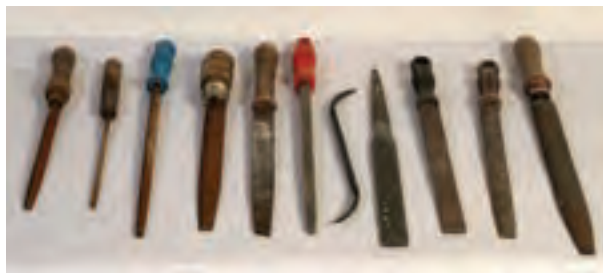
شکل ۱۵-۹- اکسیده شدن سوهان و چوبسآ به علت (رطوبت).
