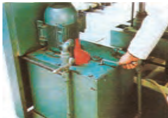
شکل ۱۳۶-۱۵- استفاده از قیف برای (روغن کارتر).
