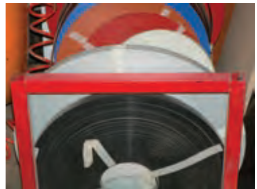
شکل ۱۵۹-۱۶- مقر فلزی نوار و انتهای نوار لبه چسبان.
