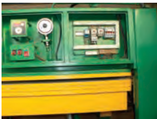
شکل ۱۵۴-۱۵. نحوه اتصال برق به کلیدی مینیاتوری در تابلوی برق پرس.
