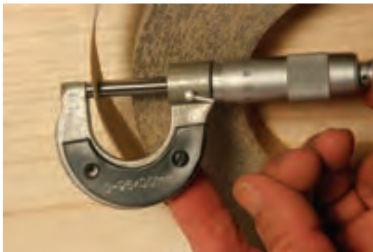
شکل ۱۶-۱۲۵- اندازه‌گیری ضخامت نوار با میکرومتر.
