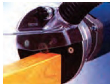
شکل ۸۵-۱۶- پرداخت لبه با فرز افقی.
