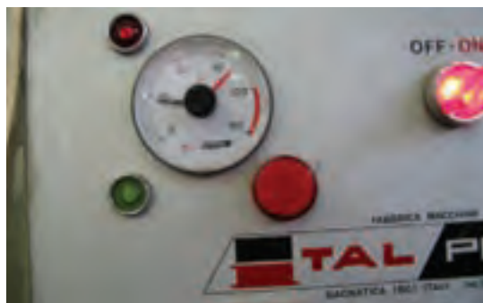
شکل ۱۳۱-۱۵. گیج تنظیم حرارت یک پرس برقی.
