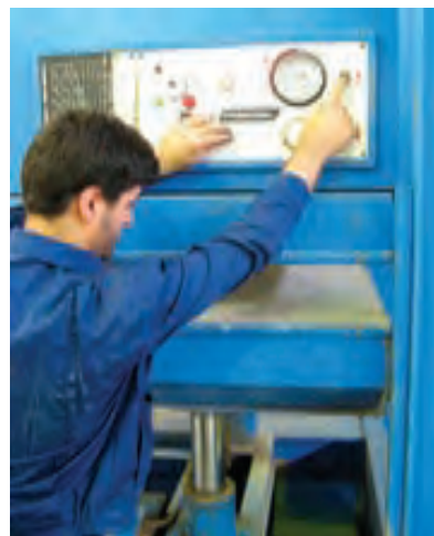
شکل ۱۵-۲۴- بالا بردن سریع اولیه صفحات پرس.
