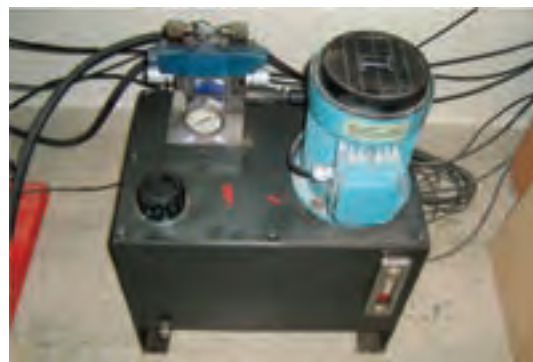
شکل ۲۱-۱۵- کارتر روغن مجهز به الکتروپمپ و دریچه شافص سطح روغن.
