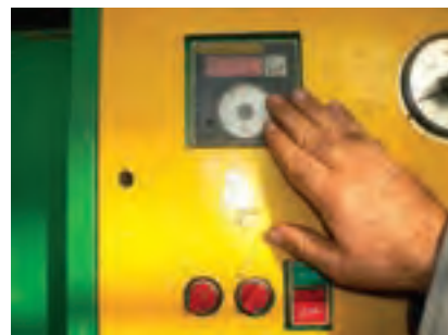
شکل ۱۷۴-۱۵- تنظیم گیج حرارت صفحات پرس.
