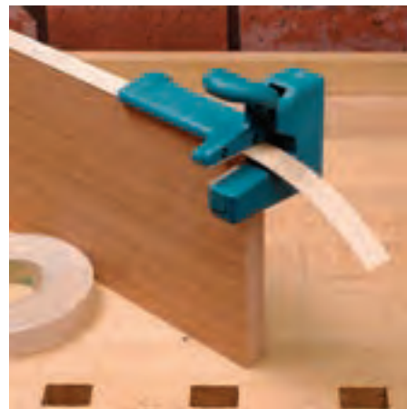
شکل ۱۶-۱۱۹ قطع اضافه سر نواری با گیوتین.
