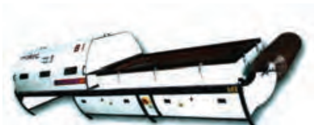
شکل ۱۵-۱۵. پرس ممبران برای پرسکاری سه بعدی.
