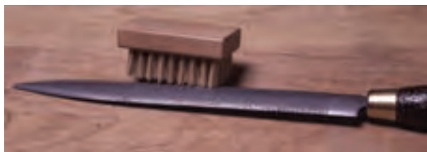
شکل ۱۹-۹- پاک کردن سوهان و چوبسآء با برس.
