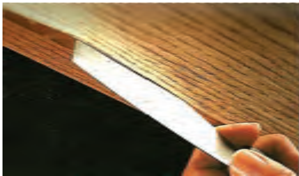
شکل ۱۳-۱۷- باز کردن دهانه (روکش با کاردک).
