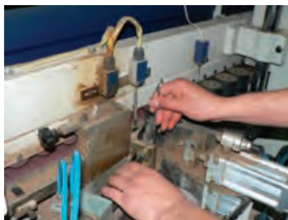
شکل ۱۷۰-۱۶- میکروسوئیچ فتری عمودی در ایستگاه غلطک چسب.
