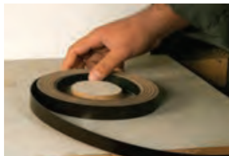
شکل ۱۳۱-۱۶- استقرار نوار در مقر میز کمک لبه چسبان.
