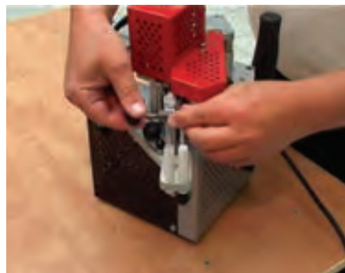
شکل ۹۸-۱۶- تنظیم عرض ورودی نوار لبه‌چسبان.
