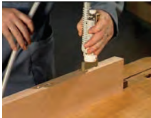
شکل ۴۵-۱۶. اتصال شیلنگ چسب به دستگاه چسب‌زن پنوماتیک.
