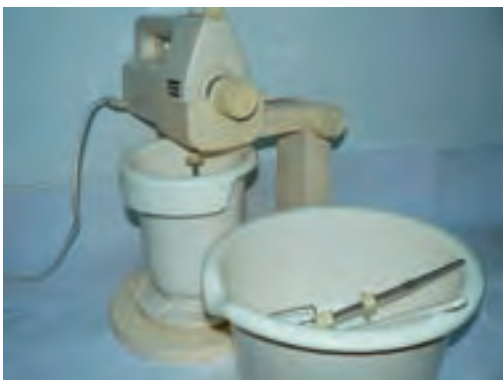
شکل ۵۶-۱۵. ظرف کوچک و همزن با یک پروانه.
