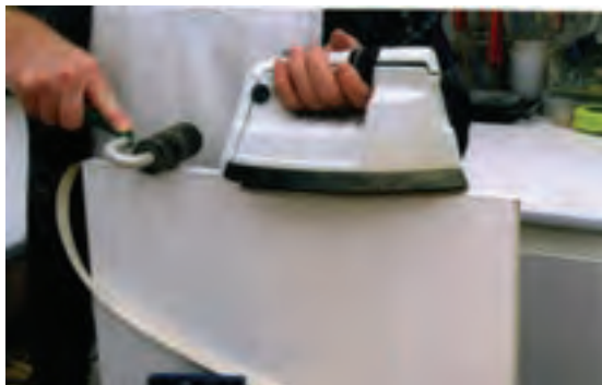
شکل ۶۱-۱۶- لبه چسبانی نوار PVC با اطو.
