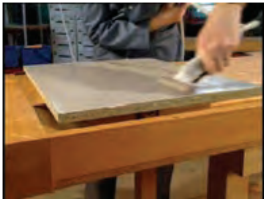
شکل ۸۷-۱۵. چسب‌زنی عرضی سطح صفحه با تیغه مخصوص.
