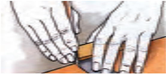
شکل ۱۲-۱۷- برش (روکش با کمک فمکش و کاتر).
