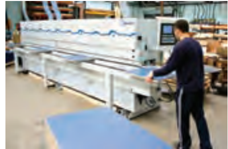
شکل ۲۱۲-۱۶- لبه چسبان اتوماتیک مفاصل شده.
