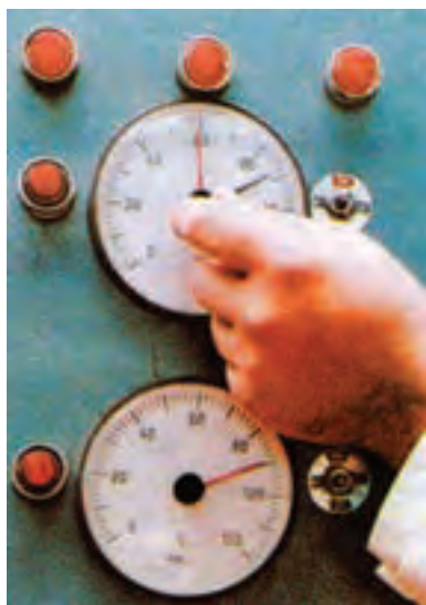
شکل ۱۷۵-۱۵- تنظیم گیج‌های حرارت پرس برقی.
