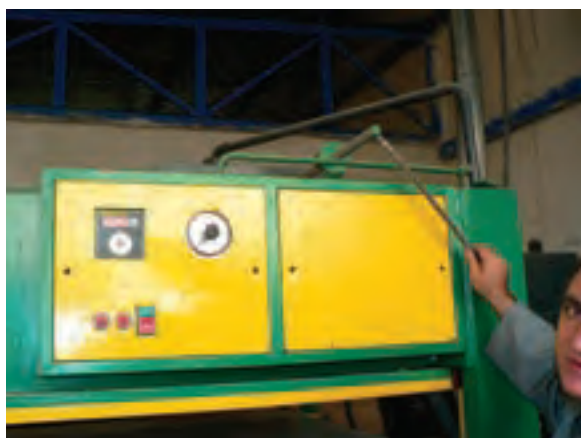
شکل ۱۸۳-۱۵- باز کردن صفحات پرس (روغنی).
