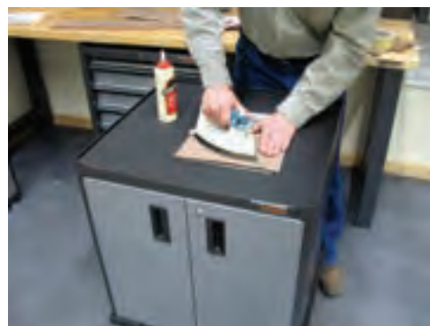
شکل ۸- ۱۷- (رفع چروک روکش با اطو).
