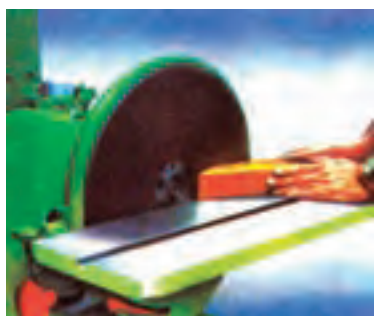
شکل ۴۳-۱۶- سنباده غلطکی دیسکی.
