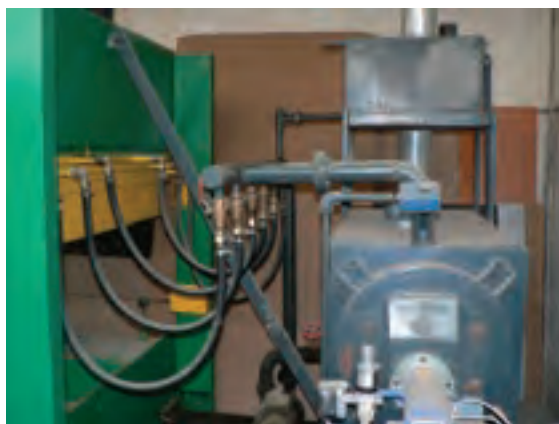
شکل ۱۳۴-۱۵. مفازن (روغن در پرس گرم) (روغنی).
