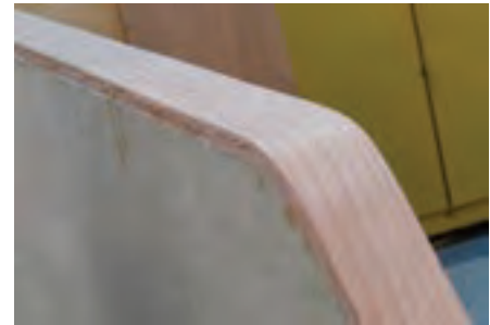
شکل ۱۲-۱۶- لبه چسبان برای محافظت قطعات.
