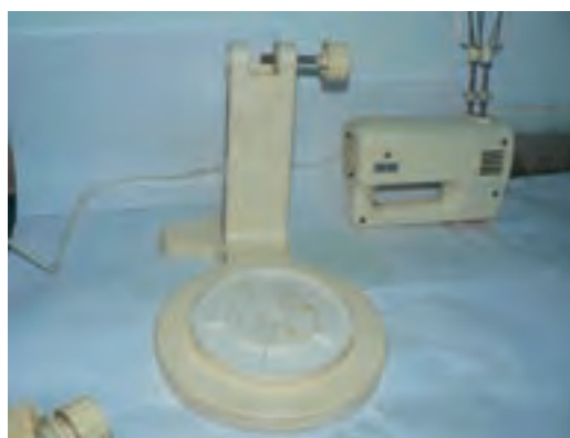
شکل ۱۴۹-۱۵- پایه چسب مخلوطکن مجهز به صفحه دوار.
