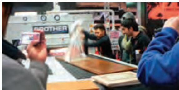
شکل ۱۶۹-۱۵. پرسکاری لترون (روی MDF به صورت رول).
