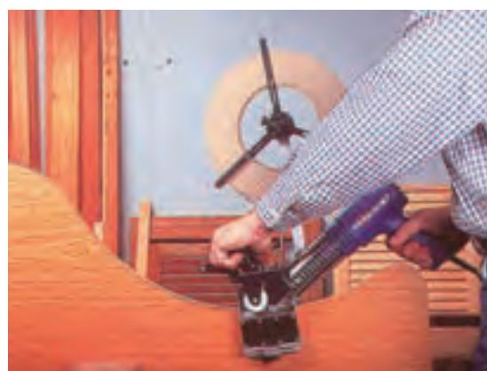
شکل ۷۰-۱۶- نوار چسبانی با لبه چسبان غلطکی دستی.
