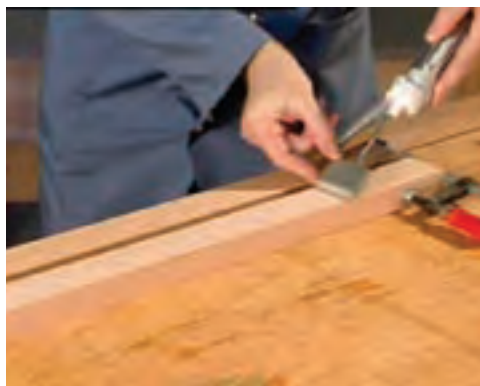
شکل ۴۷-۱۶. چسب زدن با تیغه پنوماتیک.
