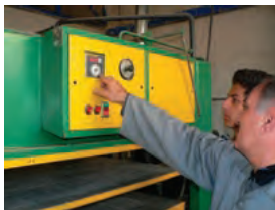
شکل ۱۲۸-۱۵. تنظیم حرارت پرس.
