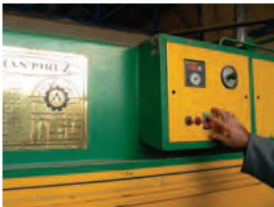
شکل ۱۴۱-۱۵. کلید استارت برای روشن کردن پرس.
