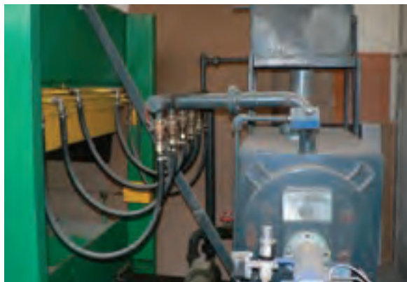
شکل ۱۷۶-۱۵- کنترل اتصال شیلنگ‌های روغن به صفحات پرس.
