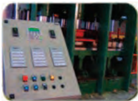
شکل ۲۱۳- ۱۵- کنترل وسائل برقی پرس.
