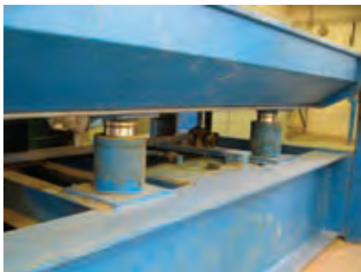
شکل ۳۲-۱۵. سیلندر و پیستون جک های پرس هیدرولیک.
