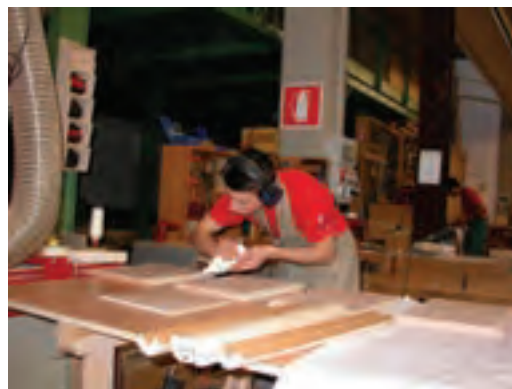
شکل ۴۹-۱۶. چسب زدن به ضخامت صفحات.
