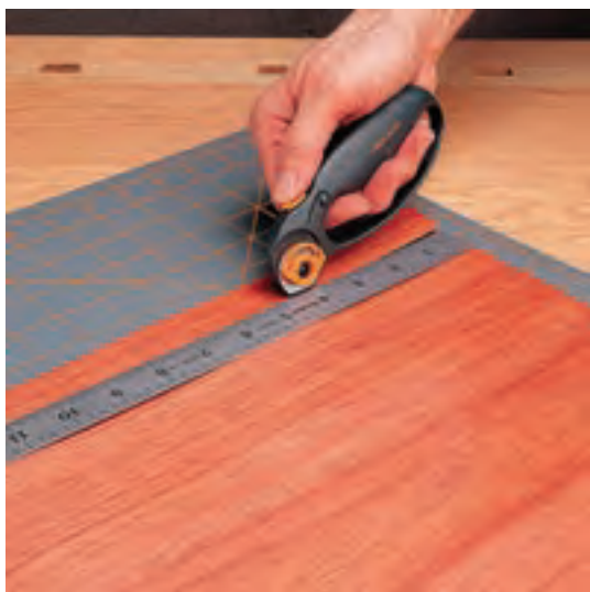
شکل ۵۸-۱۶. بریدن روکش با کاتر تیغه گرد.
