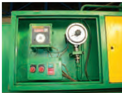
شکل ۱۵۲-۱۵. کنترل تابلوی برقی گیج های حرارت - فشار پرس (روغنی).
