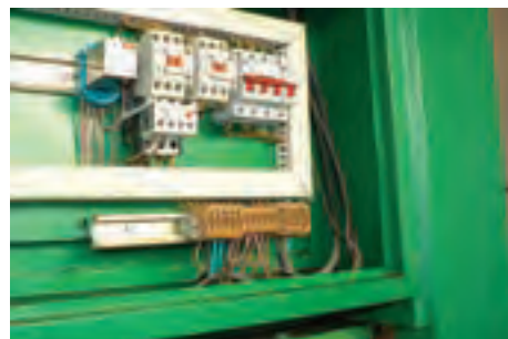
شکل ۳۸-۱۵- فیوزهای خودکار مینیاتوری روی تابلو برق پرس.
