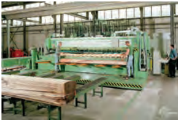
شکل ۶-۱۷. دستگاه تهیه (روکش به روش کاردی).
