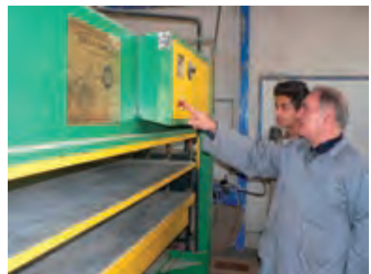
شکل ۱۶۳-۱۵- کلید روشن کردن پرس.
