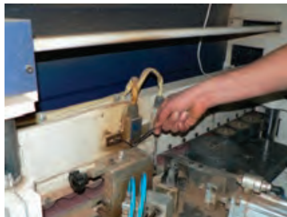
شکل ۱۷۱-۱۶- تنظیم میکروسوئیچ هدایت اولیه نوار.
