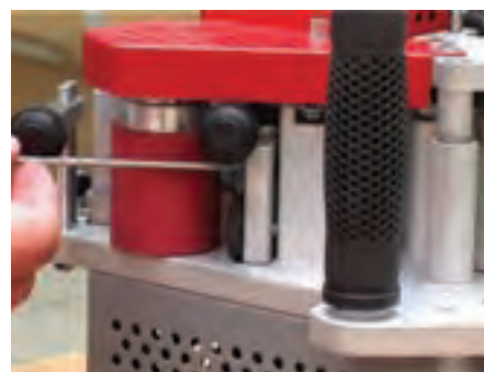
شکل ۱۰۶-۱۶- تنظیم ضخامت نوار با پیچ گوشتی.
