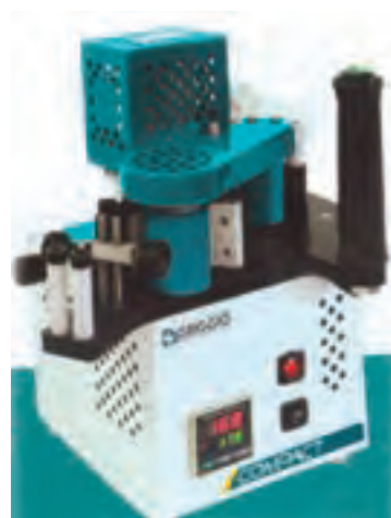
شکل ۹۱-۱۶. دستگاه منمنی و مستقیم لبه چسبان دستی و میزی با سرعت ۱ تا ۴ متر در دقیقه، قدرت موتور ۱۰/۲۵ اسب، ضخامت نوار ۰/۴ تا ۳ میلی‌متر.
