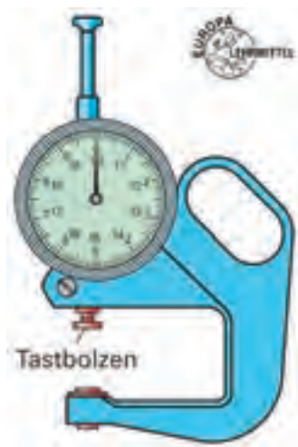
شکل ۱۵۷-۱۵. وسیله کنترل ضخامت صفحات قبل از پرسکاری.
