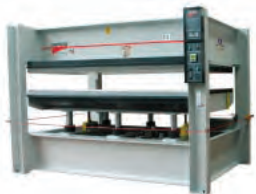
شکل ۲۰۶-۱۵ سیم قطع برق اضطراری پرس.
