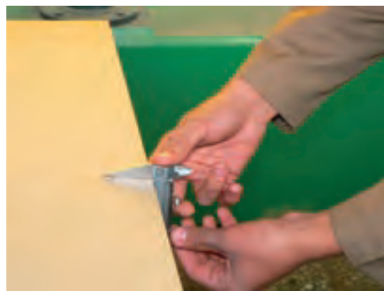
شکل ۱۵۵-۱۵. کنترل ضخامت با کولیس قبل از پرسکاری.
