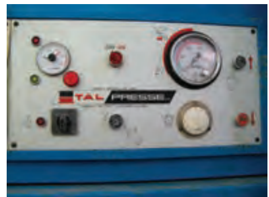
شکل ۱۶۲-۱۵- تابلو کنترل و کلید روشن کردن پرس.
