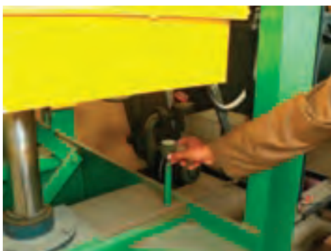
شکل ۱۴۶-۱۵. تنظیم توپی لاستیکی اهرم زیر صفحه پرس.
