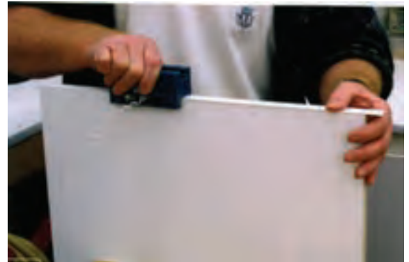
شکل ۸۰-۱۶. قیچی پرداخت دو طرفه لبه نوار.
