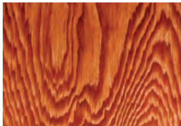
شکل ۲۹-۵- نقش مماسی ۷ شکل در چوب.
