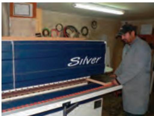
شکل ۱۸۴-۱۶. نمونه لبه چسبانی کردن صفحه کار.
