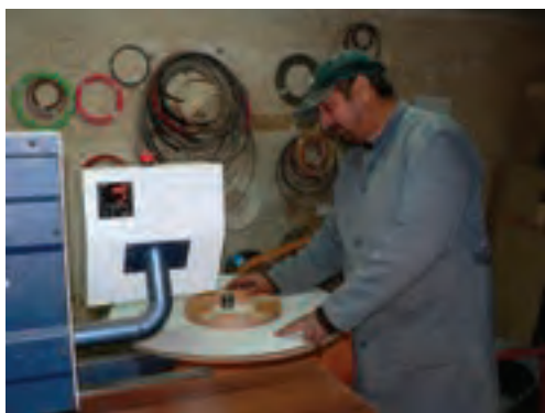
شکل ۹۶-۱۶- صفحه اتکاء دستگاه لبه چسبانی.
