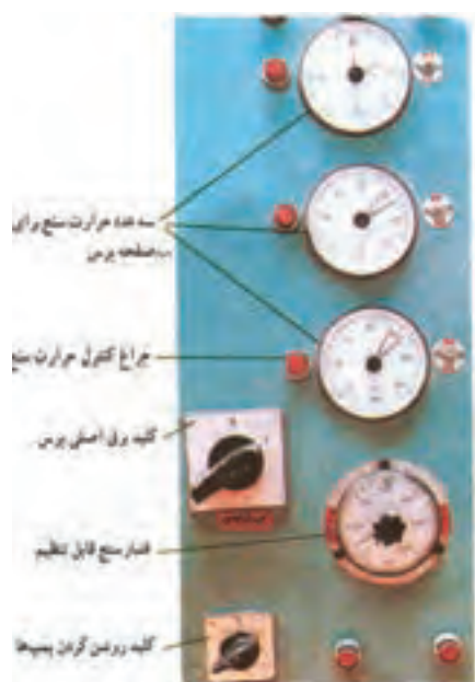
شکل ۱۳۲-۱۵. اجزای تنظیم حرارت و فشار پرس.
