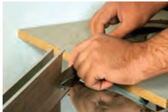
شکل ۱۳۴-۱۶- عبور دادن سر نوار از کانال گرم‌کن.
