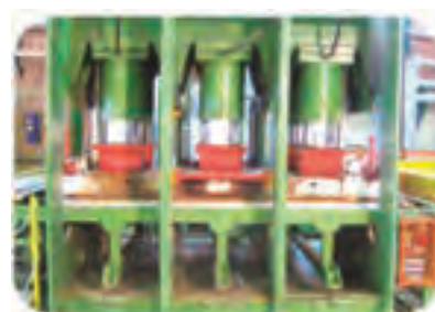
شکل ۱۰۵-۱۵. پرس هیدرولیکی گرم ۱۰۴۲ تنی.
