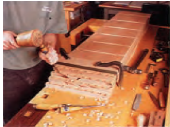
شکل ۱۶-۶. مغارکاری و ثابت کردن صفحه کار با استفاده از آهن نگهدارنده اهرمی.
