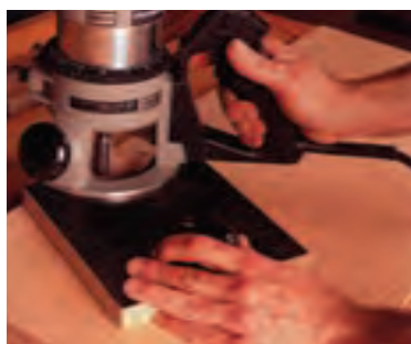
شکل ۲۱- ۱۷- استفاده از فرز دستی.
