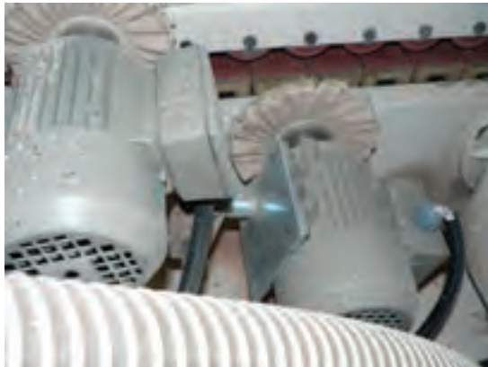
شکل ۱۷۶-۱۶- پولیش بالا و پایین لبه چسبان.
