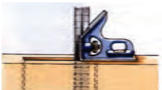
شکل ۷-۲۳ - استفاده از تراز میوه‌ای گونیای مرکب.
