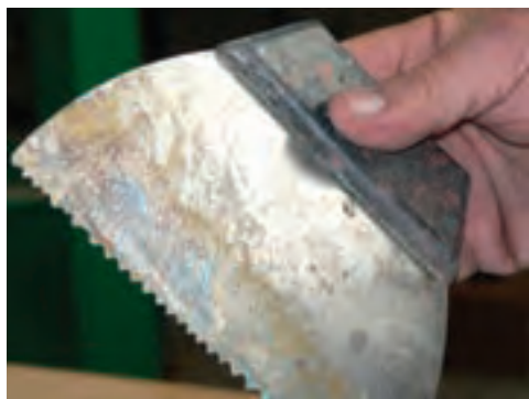
شکل ۷۸-۱۵. استفاده از کاردک شانه‌ای.
