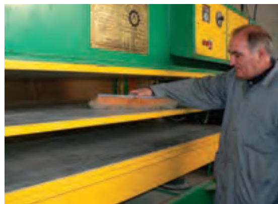
شکل ۱۷۰-۱۵ تمیز کردن صفحه قبل از پرسکاری.
