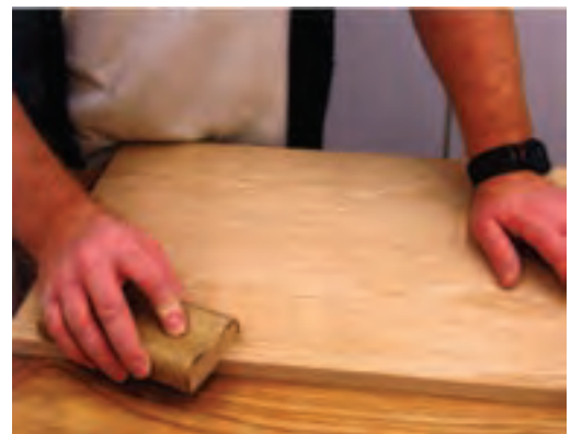
شکل ۸۹-۱۶ پرداخت با سنباده دستی لبه نوار.
