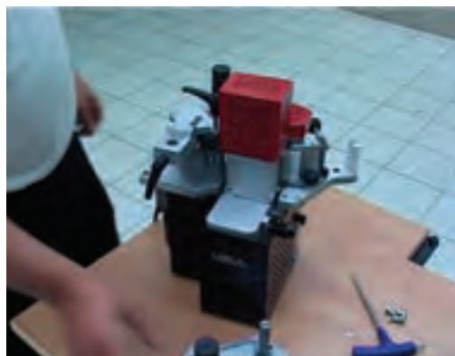
شکل ۱۱۲-۱۶- آماده کردن لبه چسبان برای کار مستقیم.
