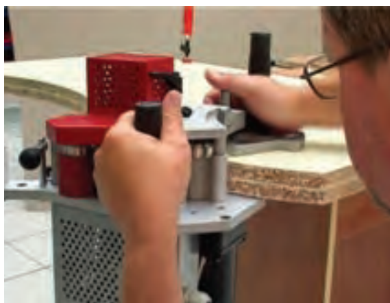
شکل ۱۰۷-۱۶- استقرار دستگاه (روی ضخامت صفحه کار).
