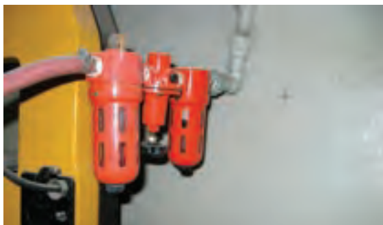
شکل ۱۴۸-۱۶- فیلتر رطوبت هوای فشرده.
