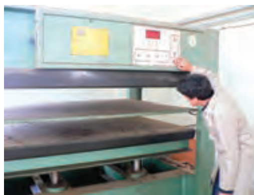
شکل ۱۵۸-۱۵- کنترل بین صفحات پرس بعد از باز کردن آن.
