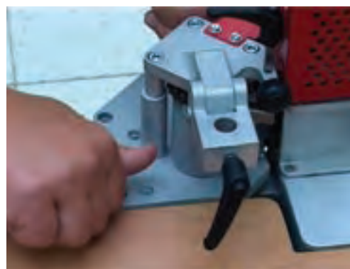
شکل ۱۱۳-۱۶- نصب دستگاه روی شابلون صفحه میز کار.
