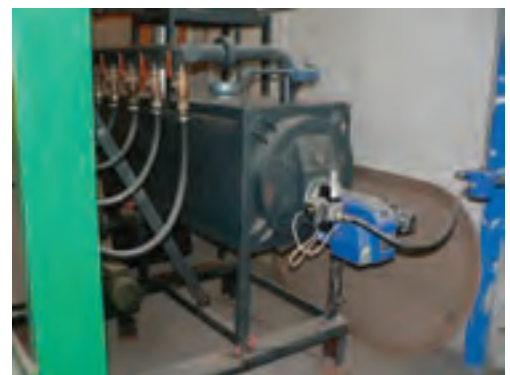
شکل ۱۱۹-۱۵. کنترل مشعل و دیگ داغ‌کننده روغن.
