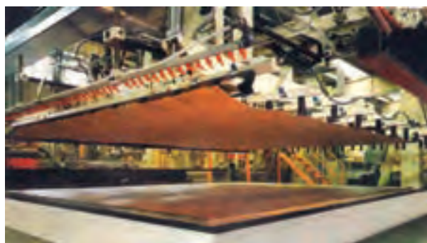
شکل ۱۰۹-۱۵. استقرار ورق ملامینه روی صفحات.
