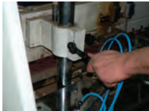
شکل ۱۸۲-۱۶. شل کردن بست ستون استقرار قسمت فوقانی.
