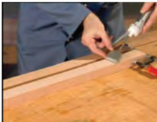
شکل ۸۴-۱۵- چسب زن دستی پنوماتیک.
