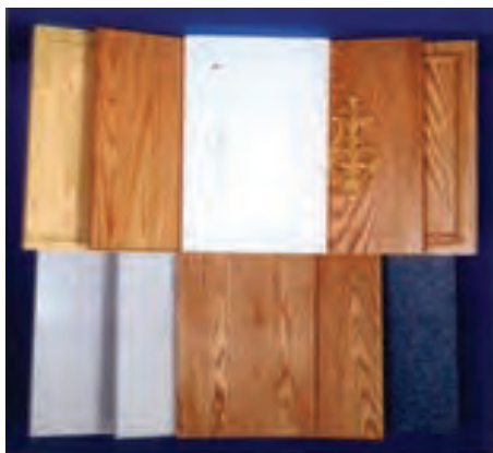
شکل ۳۹-۱۶- انواع صفحات روکش و لبه چسبانی شده.
