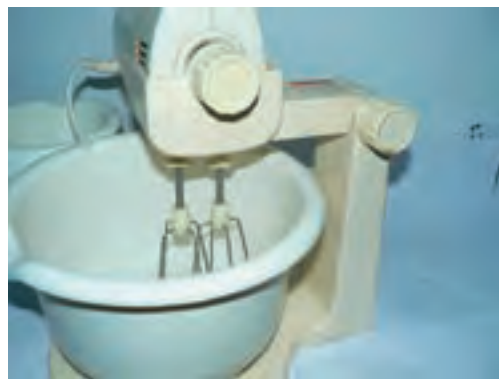
شکل ۵۳-۱۵. استقرار موتور روی دستگاه همزن.
