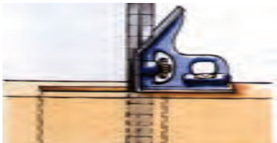
شکل ۷-۲۲ - علامت‌گذاری و سوزن فطکشی.
