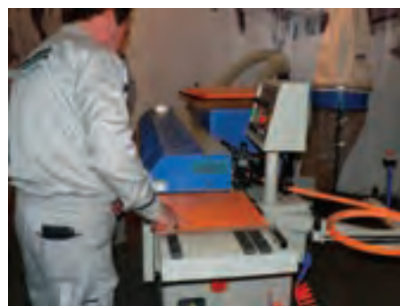
شکل ۲۰۹-۱۶- لبه‌چسبانی با استفاده از نوار چسب.
