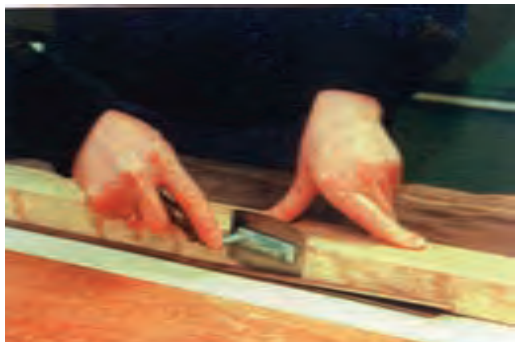
شکل ۵۷-۱۶. بریدن روکش چوبی با اره (روکش بر).
