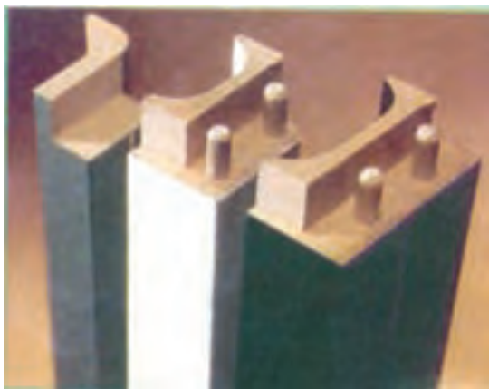
شکل ۱۰-۴- تخته فیبر برای سافت اتصالات.
