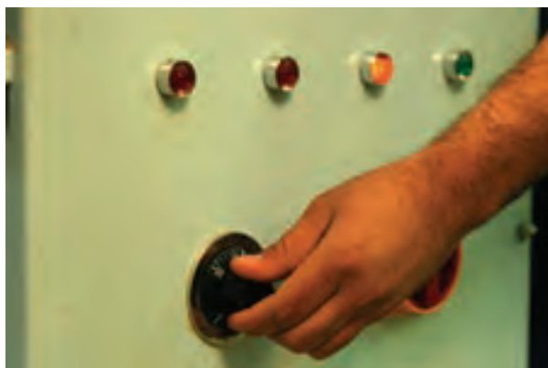
شکل ۱۳۳-۱۶- تنظیم حرارت با گیج مدرج مخصوص.
