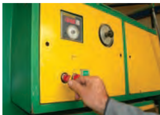
شکل ۱۵۱-۱۵. تابلوی برق اختصاصی (روی پرس روغنی).
