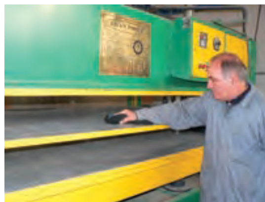
شکل ۱۵۹-۱۵- قبل از پرسکاری صفحات پرس را پاک کنید.
