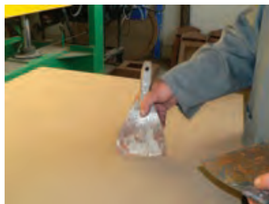
شکل ۷۷-۱۵. کاردک ساده در پخش کردن چسب.
