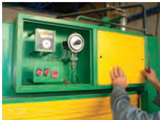
شکل ۱۵۳-۱۵. تابلوی اتصال برقی گیج های فشار و حرارت.
