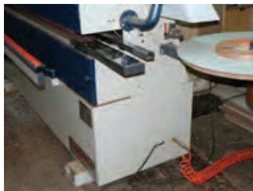
شکل ۱۷۸-۱۶- دهانه و روی صفحه کار برای لبه‌چسبانی.
