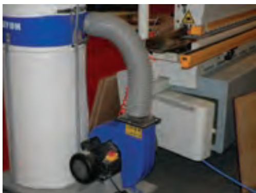
شکل ۱۹۸-۱۶. نصب مکنده به ماشین لبه چسبان.
