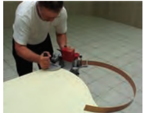
شکل ۱۰۸-۱۶. لبه چسبانی با دستگاه قوسی.
