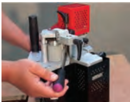
شکل ۱۶-۱۲۰ باز کردن پیچ تنظیم چسب.
