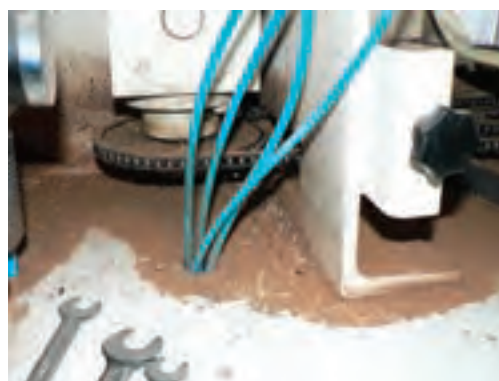
شکل ۱۶-۲۰۱ روغن‌کاری ممورها و چرخ زنجیرها.
