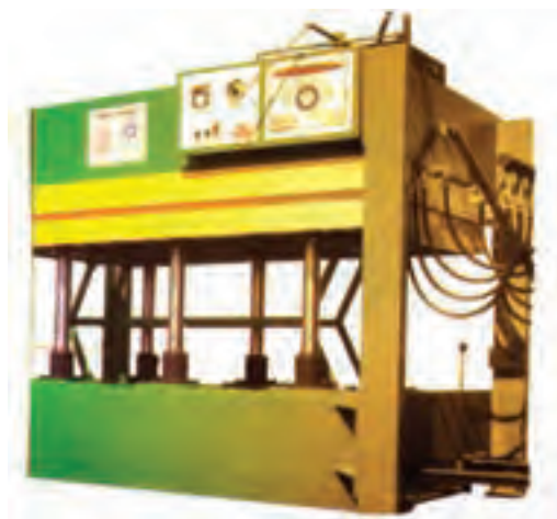
شکل ۱۶۱-۱۵- پرس یک طبقه (روغنی).
