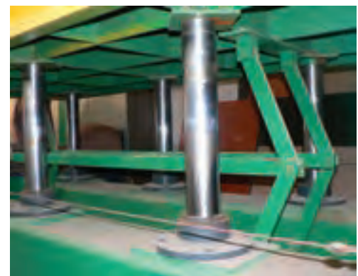
شکل ۱۴۸-۱۵. جک و سیلندرهای زیر پرس.
