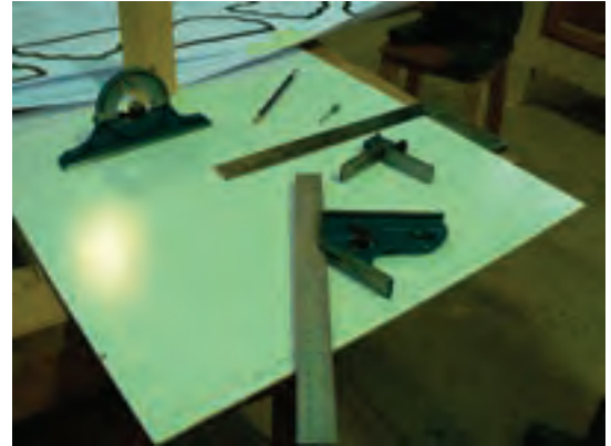
شکل ۱۰-۸. گونیای مرکب و اجزاء آن.
