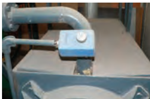
شکل ۱۲۹-۱۵. حرارت سنج (روی دیگ روغن پرس روغنی).
