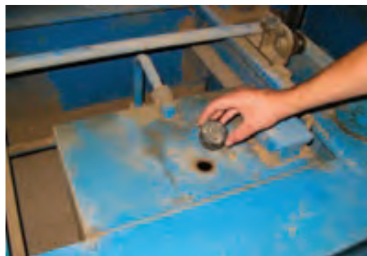
شکل ۲۰-۱۵- باز کردن دریچه کارتر روغن.
