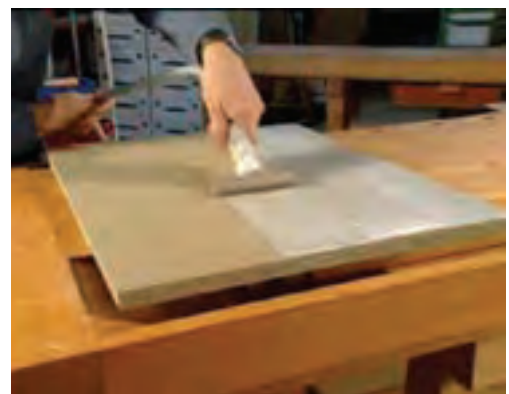
شکل ۸۶-۱۵. چسب‌زدن طولی صفحه با تیغه مخصوص.
