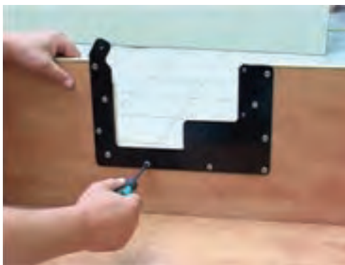
شکل ۱۱۱-۱۶. نصب شابلون برای استقرار دستگاه لبه چسبان.
