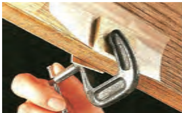
شکل ۱۵-۱۷- بستن و چسباندن با پیچ دستی.
