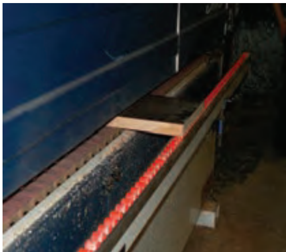
شکل ۱۶۹-۱۶- مرکب قطعه کار و برخورد به میکروسوئیچ داخل ماشین.
