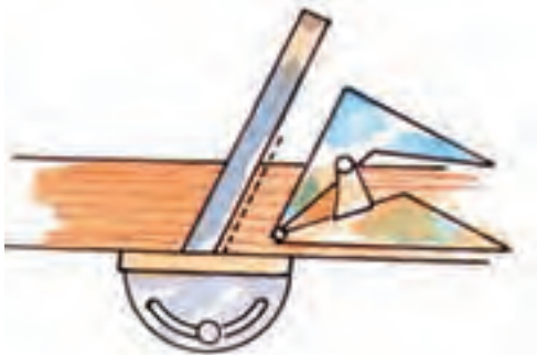
شکل ۵-۸. اندازه‌گیری و انتقال زاویه با استفاده از گونیا (بازشو و نقاله).
