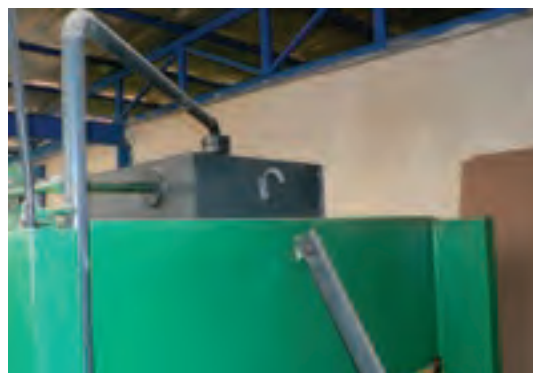
شکل ۱۴۴-۱۵. کارتر (روغن) در بالای پرس (روغنی).
