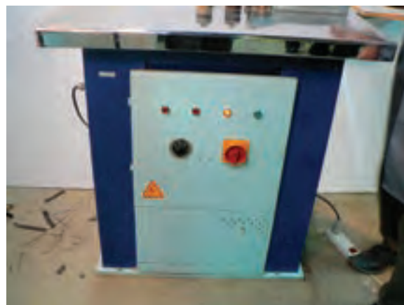
شکل ۳۸-۱۶- کلید روشن کردن و درجه تغییر حرارت ماشین.
