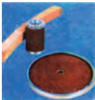
شکل ۴۴-۱۶- سنباده بالشتکی عمودی.
