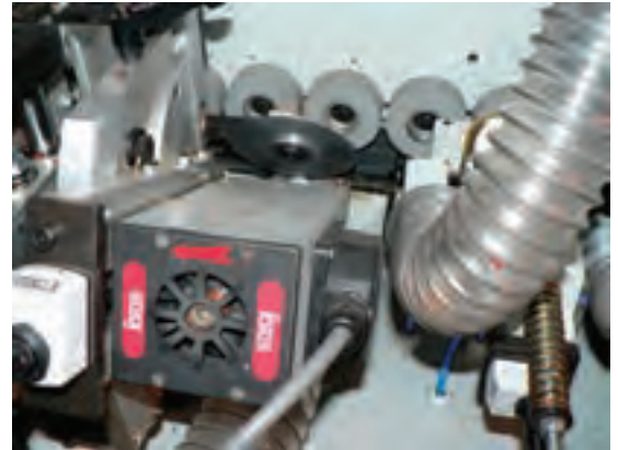
شکل ۱۹۰- ۱۶- تیغه فرز گوشه در لبه چسبان اتوماتیک.
