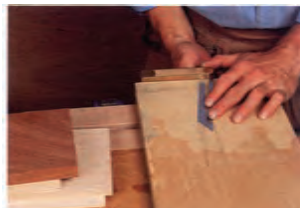
شکل ۷-۲۱ - ترسیم خطوط زاویه‌دار با گونیای باز شو.
