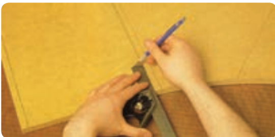
شکل ۸-۲۸ خط‌کشی محل قرارگیری بدنه‌ها در زیر صفحه میز
