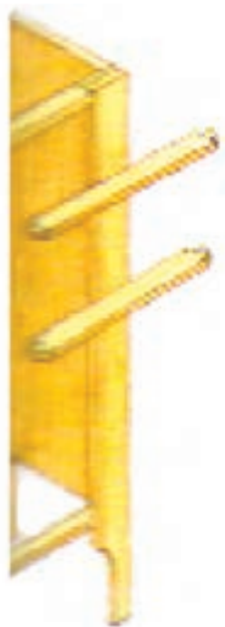
شکل ۶۳- ۸ موقعیت قیدهای عرضی داخلی در کابینت پایه‌دار
