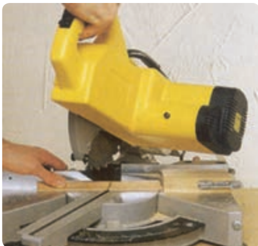
شکل ۲-۱۲- برش قائم با اره گرد فارسی بر
