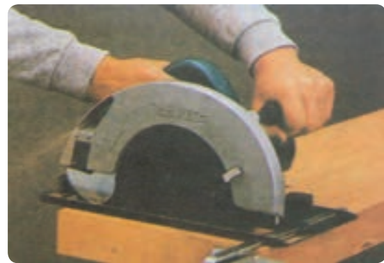
شکل ۲-۳۶ برش به وسیله گونیای دستگاه
