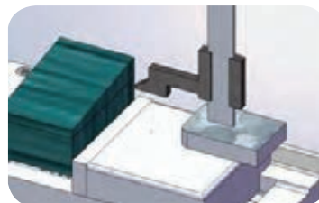
کنترل دو سر خط کشیده شده بر روی قطعه با کولیس پایه دار
