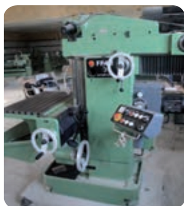
فلکه های دستگاه برای جابجایی دستی
