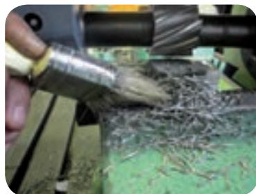
نحوه دور کردن براده ها
