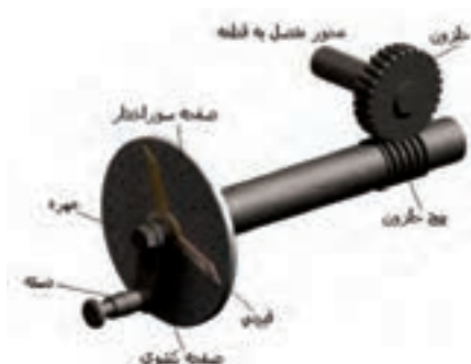
نمای کامل تری از سیستم چرخ حلزون و پیچ حلزون در دستگاه تقسیم غیر مستقیم
