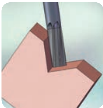
بستن یک تیغه فرز انگشتی و انحراف کله گی یا قطعه کار
