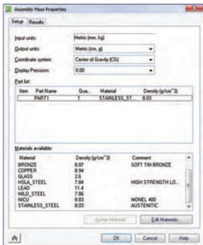
برای اختصاص دادن یک متریال به یک قطعه ابتدا آن قطعه را در فهرست قطعات انتخاب می‌کنیم و از بخش Materials Available متریال مورد نظر را برای آن انتخاب می‌کنیم. سپس دکمه‌ی Assign Material را کلیک می‌کنیم.
