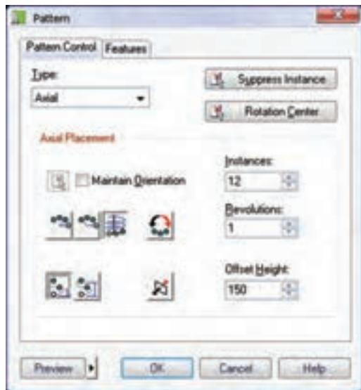
۹. پنجره‌ی Pattern را OK نمایید و با استفاده از آیکن Toggle Shading/Wireframe در نوار ابزار آیکن Mechanical View مدل را در حالت سایه‌پردازی مشاهده کنید.
