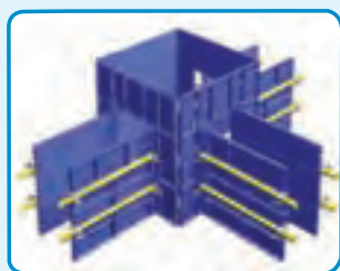
شکل ۳-۲۸- قالب فلزی برای اجرای پی
