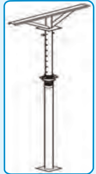
شکل ۳-۲۲- شمع فلزی کامل تنظیم ارتفاع
