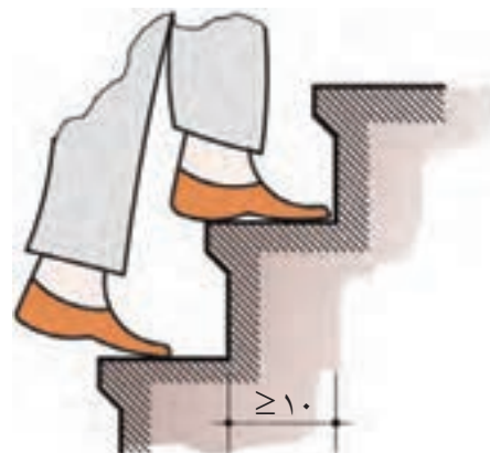
شکل ۱۶-۳ کوچک‌ترین اندازه‌ی کف پله در پله‌های پیچ
