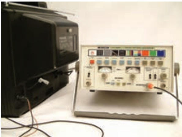
شکل ۱۹۲-۴ اتصال پترن ژنراتور به تلویزیون
