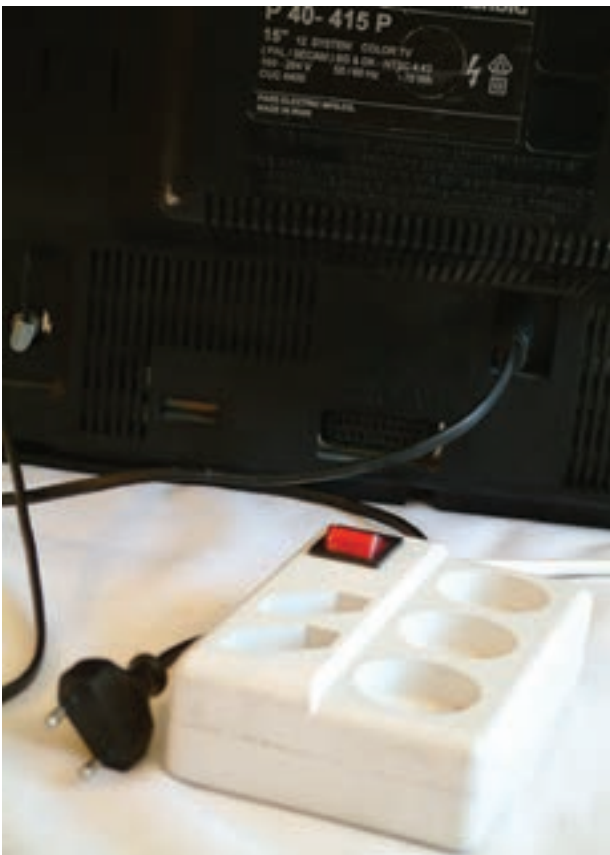
شکل ۴-۸۲- در هنگام ایجاد عیب روی برد، برق تلویزیون را قطع کنید.
