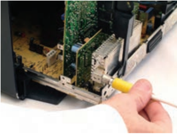
شکل ۴-۸۱- در اتصال سیم رابط به تیونر، به دستگاه فشار زیاد وارد نکنید.
