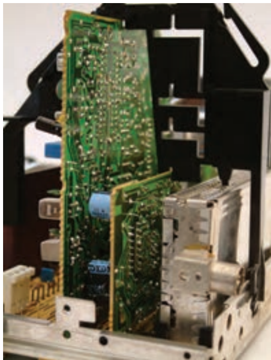
شکل ۴-۳۳- مدول‌های تیونر و IF و RGB در روی سوکت و برد
