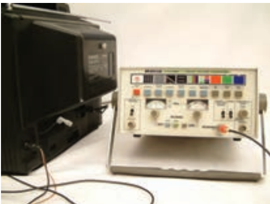
شکل ۳۹-۳- اتصال پترن ژنراتور به تلویزیون
