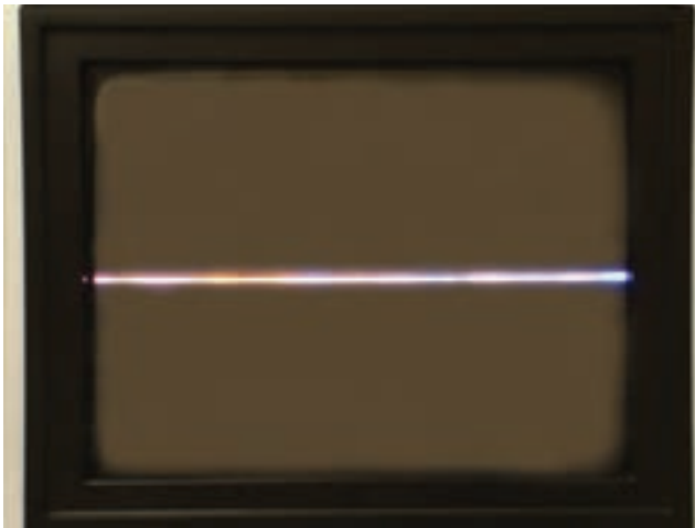
شکل ۲-۸۶- اسیلاتور عمودی از کار افتاده است.
