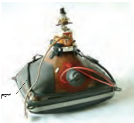
شکل ۲۰۰-۱ محل قرار گرفتن سیم پیچ مغناطیس زدا
