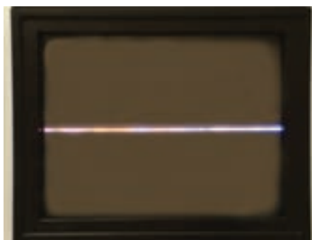
شکل ۲-۴۰- نوسان ساز عمودی از کار افتاده است.
