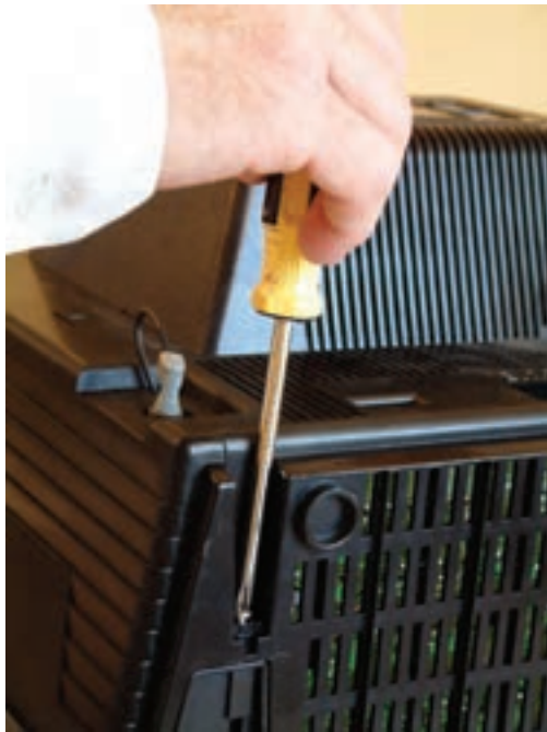
شکل ۲-۴۲- نحوه‌ی باز کردن قاب پشت تلویزیون
