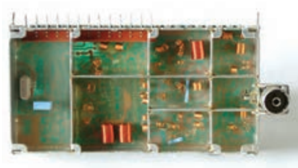
شکل ۲-۲۴- محفظه‌ها و سیم پیچ‌های تیونر
