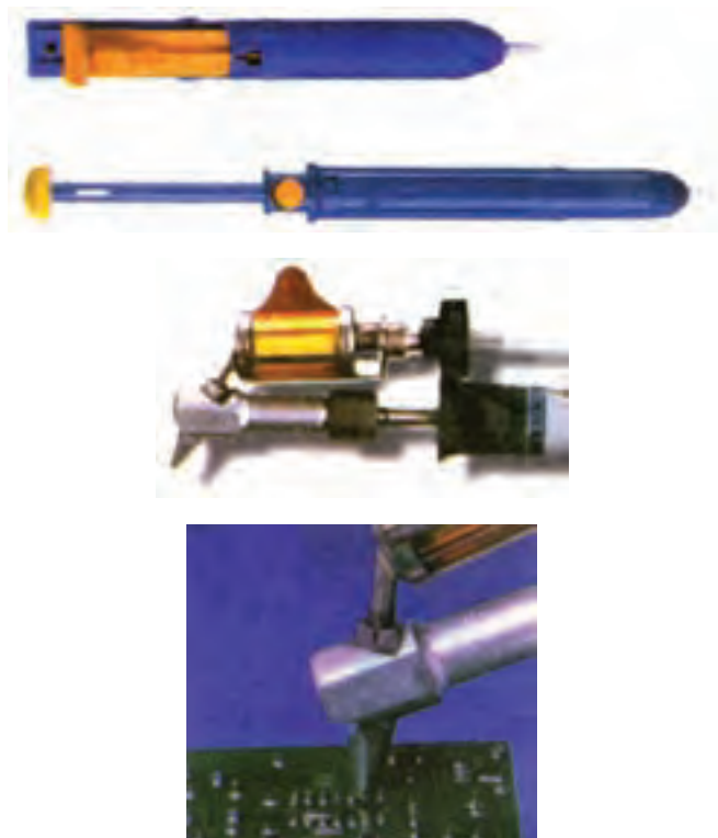
شکل ۱۳۶-۱- قلع کش پیستونی و قلع کش حرارتی
