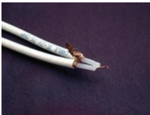
شکل ۱-۶۳- سیم کابل نباید دو تکه باشد.
