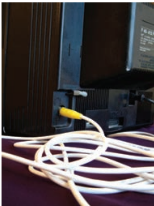
شکل ۱-۶۴- از جمع کردن سیم اضافی کابل خودداری شود.
