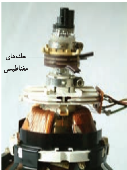
شکل ۹۸-۱- حلقه های مغناطیسی روی گردن لامپ
