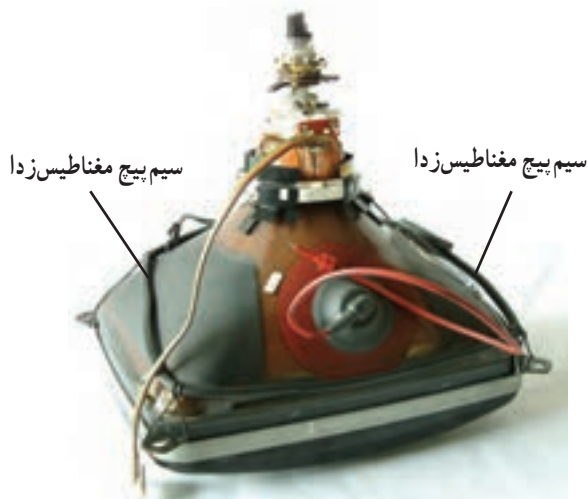
شکل ۱-۱۰۶- سیم پیچ مغناطیس زدا در روی قسمت شیپوری لامپ تصویر
