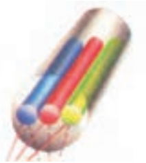
شکل ۹۳-۱- سیستم تولید اشعه In Line
