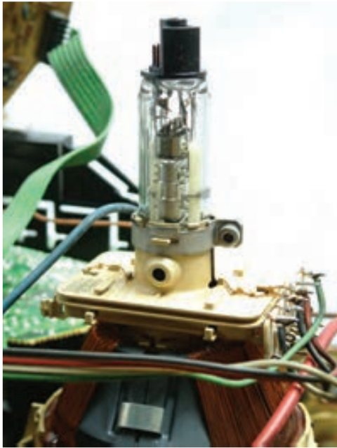
شکل ۱-۷۱-الف - شکل لامپ تصویر و پایه‌های آن
