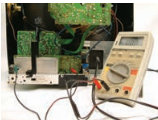
شکل ۱-۶۱° اتصال ولت‌متر به پایه‌ی ۱۰
