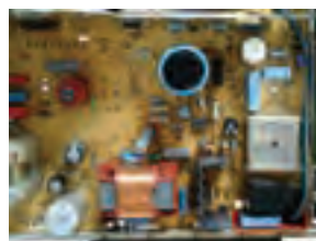
شکل ۱-۶۲- مدار کامل منبع تغذیه همراه با شکل قطعات و برد مدار چاپی آن
