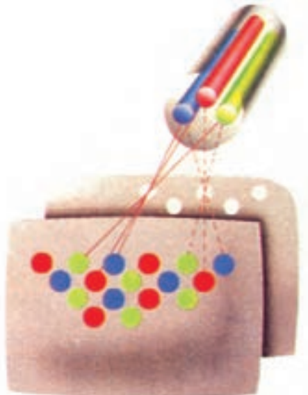
شکل ۱-۲۰ تفنگ الکترونی لامپ تصویر مثلثی ( \Delta )
