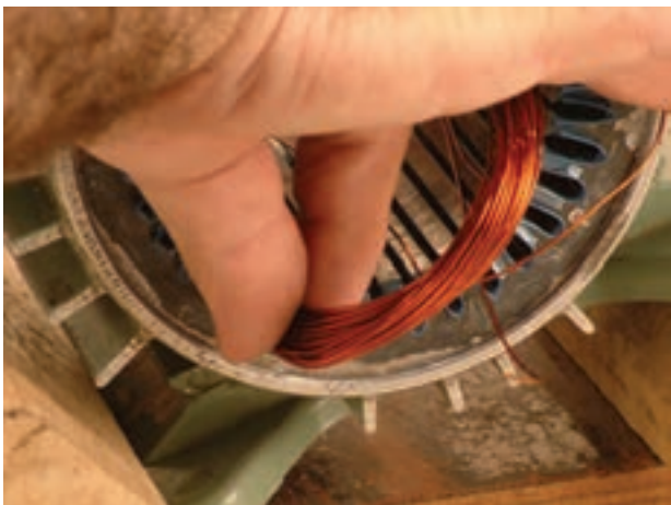
شکل ۲-۶- موقعیت انگشتان شست و سیبانه در جای گذاری کلاف‌ها در داخل شیار استاتور
