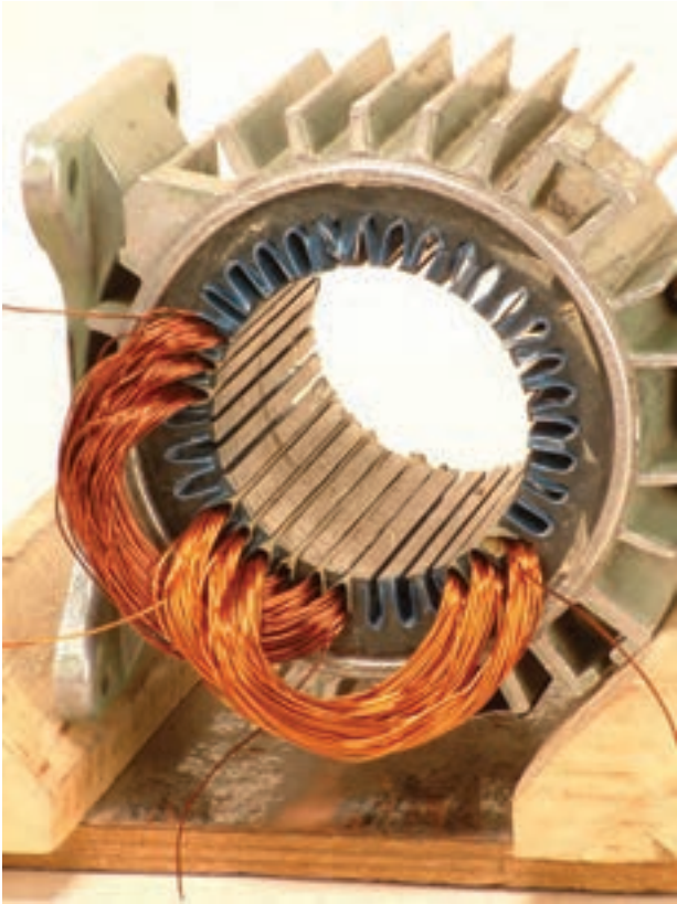
شکل ۲-۲۲- شروع گروه کلاف سوم از شیار شماره ۱۳
