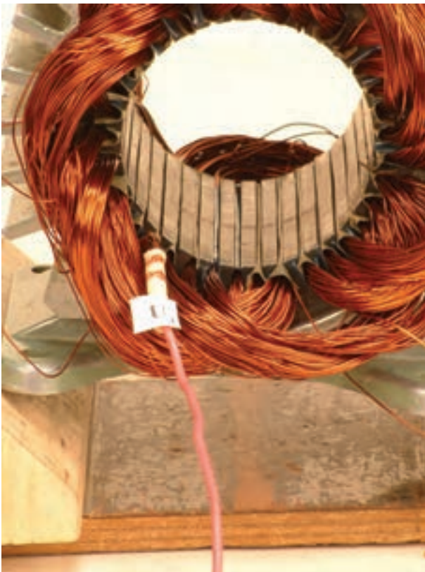
شکل ۱۱-۳- اتصال سیم افشان به ابتدا و انتهای فاز و برچسب زدن آن
