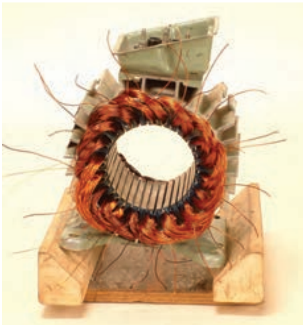
شکل ۱۳-۳ شماره گذاری شیارها
