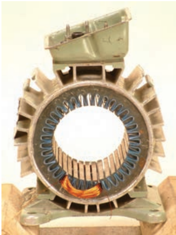
شکل ۲۹-۲-ج - قراردادن کلاف شماره ۱
