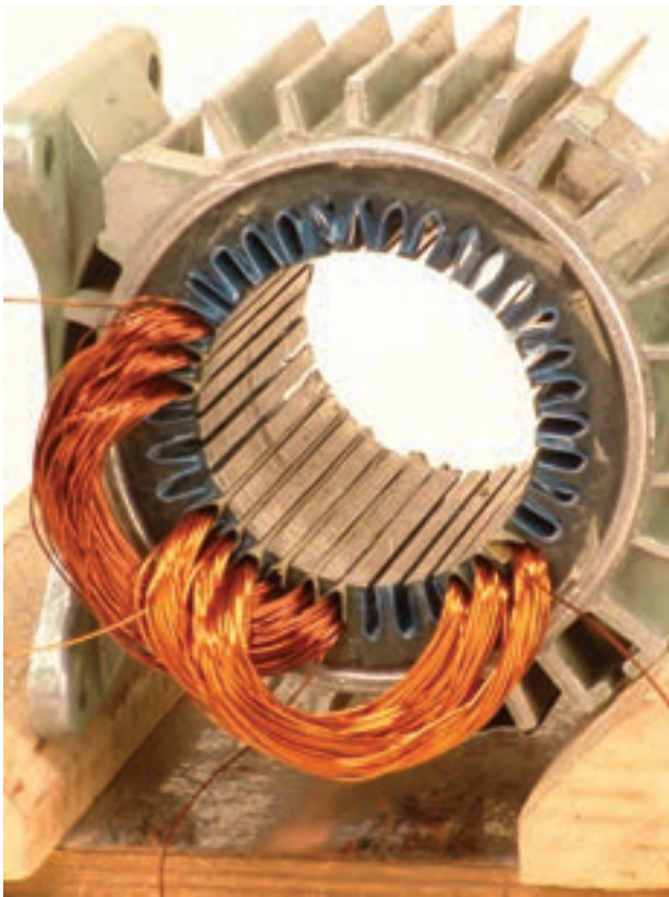
شکل ۲۱-۲- قرارگرفتن بازوهای گروه کلاف دوم در داخل شیارها
