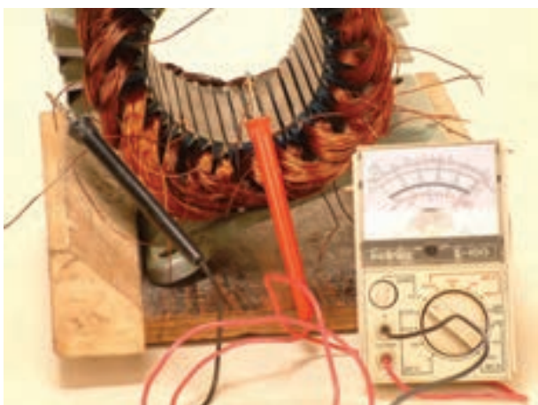
شکل ۳-۴- آزمایش ارتباط کلاف‌های گروه کلاف شماره ۱
