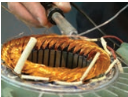
شکل ۴-۷- لحیم کاری محل اتصال سیم ها
