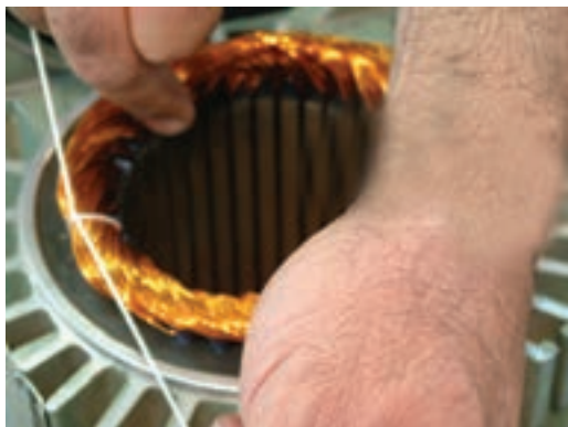
شکل ۴-۱۴- گره زدن یک سر نخ
