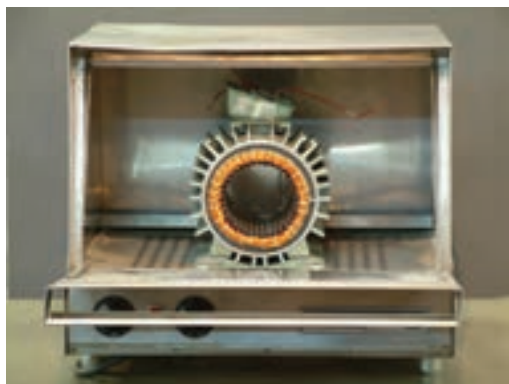
شکل ۲۰-۴- گرم کردن استاتور
