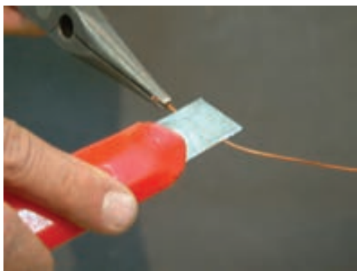
شکل ۴-۱-ج - پاک کردن لاک به روش تراشیدن
