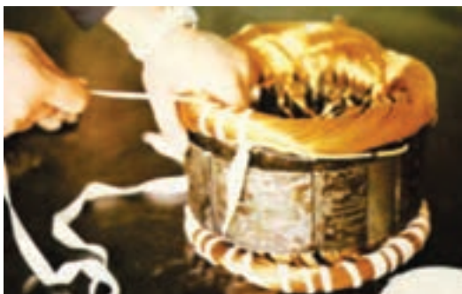
شکل ۴-۱۸– نواربندی سیم‌های استاتور
