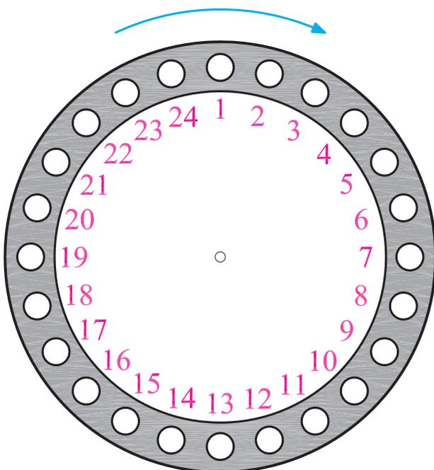
۱۱- شیار شروع و جهت سیم بندی را روی شکل (۲-۷۷) مشخص کنید.
