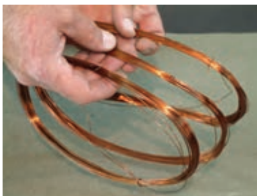
شکل ۱۹-۳ - درآوردن کلاف از قالب
