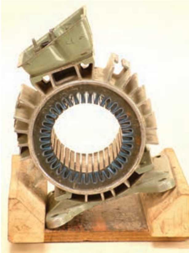
شکل ۲۹-۲-ب - انتخاب شیار شروع سیم بندی
