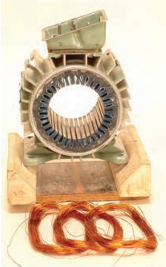
شکل ۲-۱۴- تعیین محل قرار گرفتن کلاف‌ها
