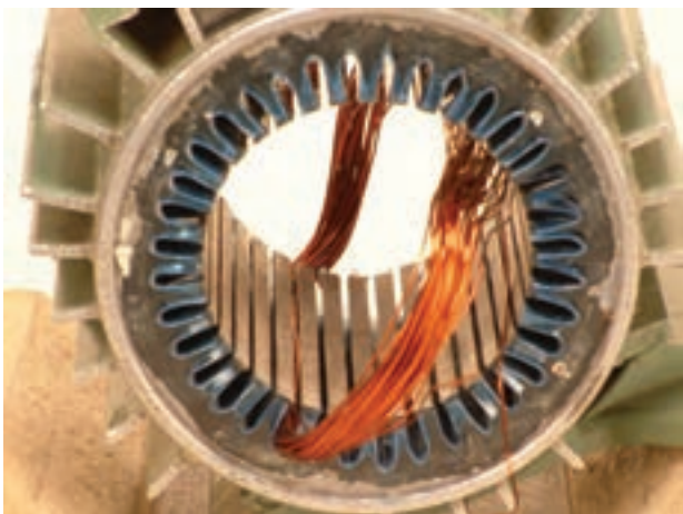
شکل ۲-۷- قرار گرفتن یک بازو در داخل یک شیار
