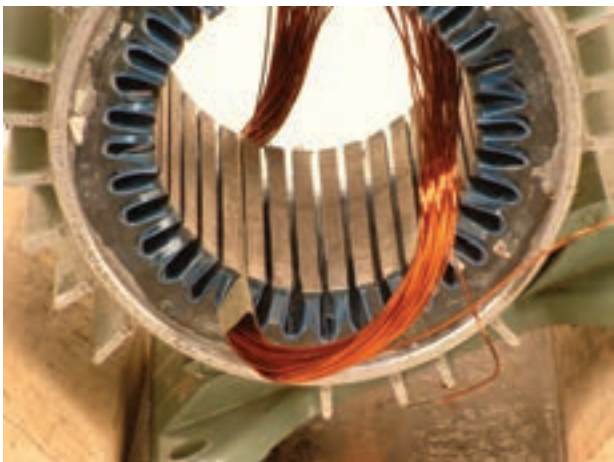
شکل ۲-۹- پوشاندن روی بازوها توسط کاغذ پرشمان
