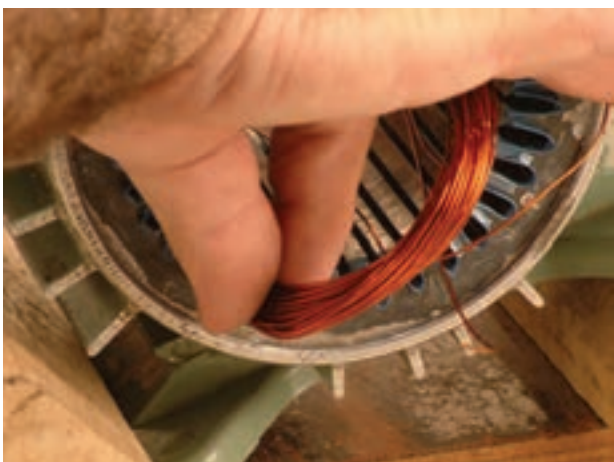
شکل ۲-۶- موقعیت انگشتان شست و سبابه در جای گذاری کلاف‌ها در داخل شیار استاتور
