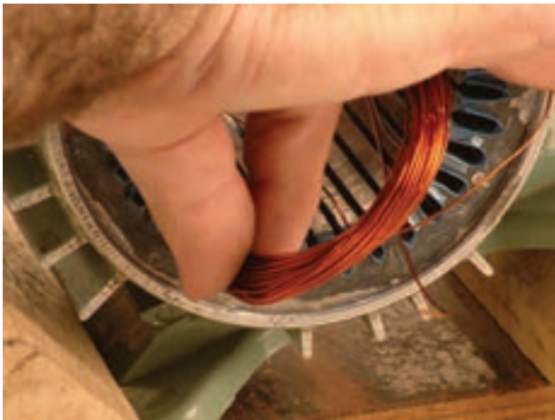
شکل ۲-۱۵- قراردادن بازوی شماره یک در شیار شماره ۱
