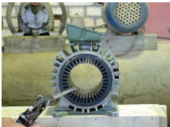
شکل ۱-۳۱ - بادگیری قطعات جدا شده
