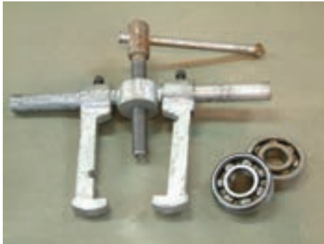
شکل ۱-۴۷- بلبرینگ‌ها پس از جدا شدن از محور
