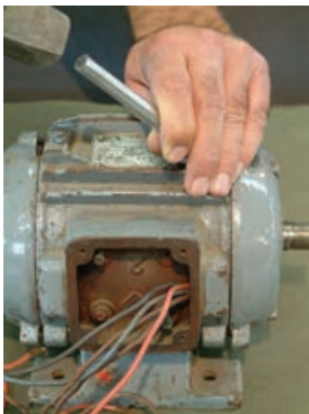
شکل ۱-۲۶- باز کردن درپوش موتور
