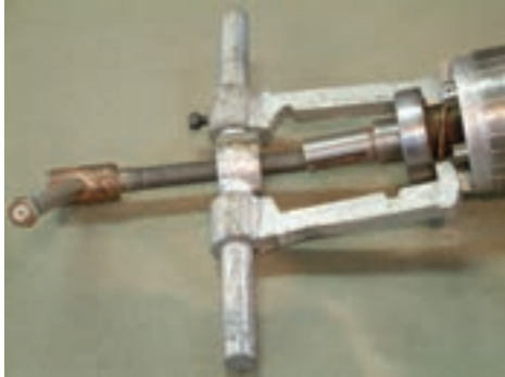
شکل ۱-۴۶- استقرار بلبرینگ کش روی محور روتور
