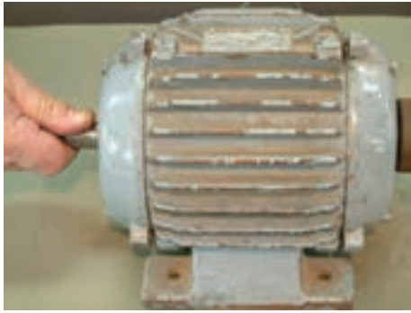
شکل ۱-۴۵- بررسی لقی بوش‌ها
