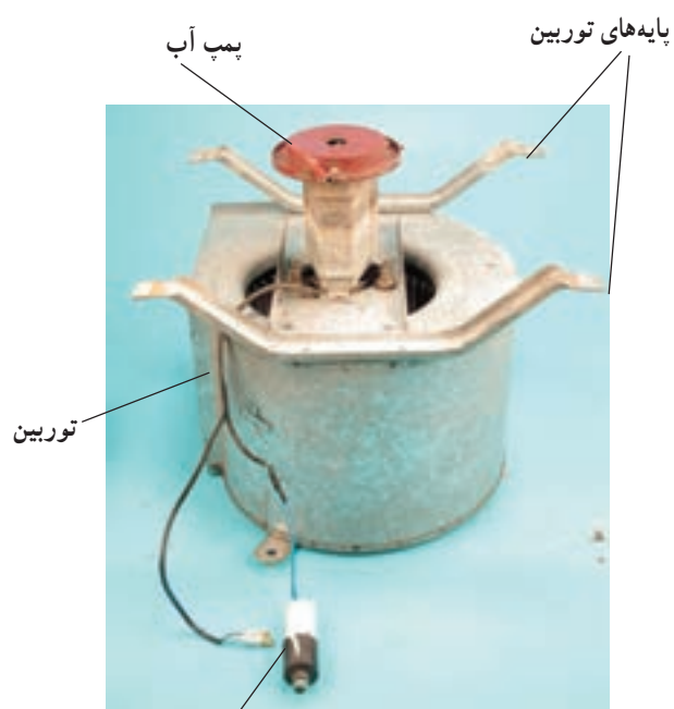
خازن دائم کار موتور شکل ۵۰۷-۸
