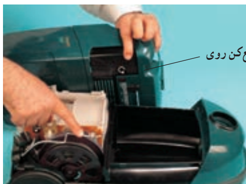
رابط میله‌ای اهرم ضامن سیم‌جمع‌کن شکل ۶-۲۰۷
