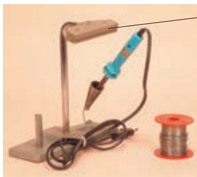
نگهدارنده‌ی بُرد الکترونیکی
