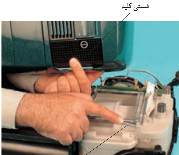
رابط شستی کلید و اهرم کلید
