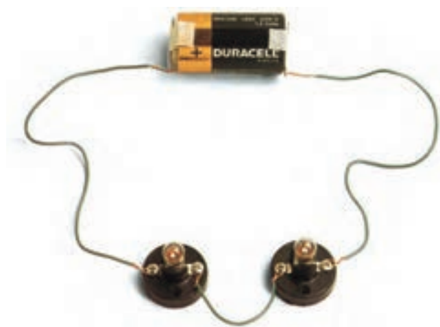
شکل ۵-۳- مدار واقعی دو لامپ به صورت سری
