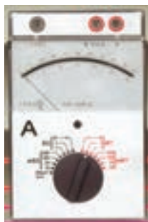
شکل ۵-۲۴- یک نمونه آمپر متر آزمایشگاهی
