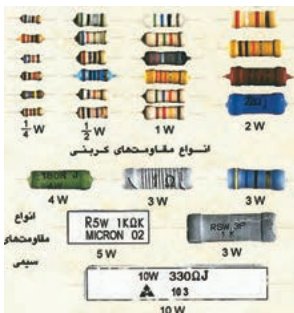
شکل ۱۷-۶- استانداردهای توان در مقاومت ها
