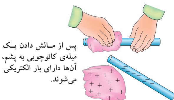
شکل ۱۸-۳- الکتریسیته مالشی (اثر تریبو الکتریک)
