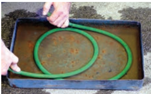
شکل ۲-۹۹ – کنترل نشتی شیلنگ در آب
