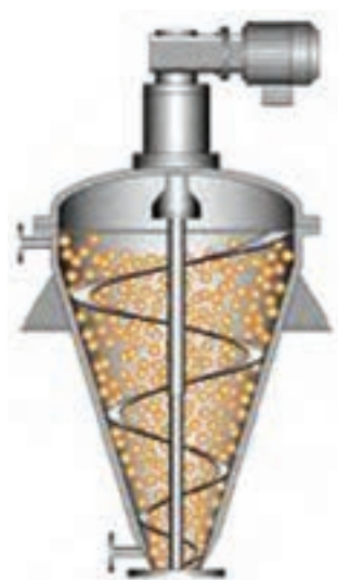
شکل ۱۰-۱۱- مخلوط‌کن ماریپچ عمودی
