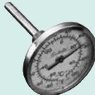
شکل ۱۰-۲- دماسنج بی‌متال
