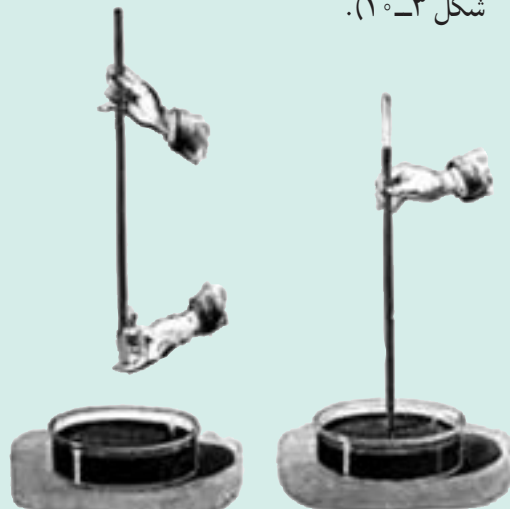
شکل ۳-۸- تهیه بارومتر جیوه‌ای
