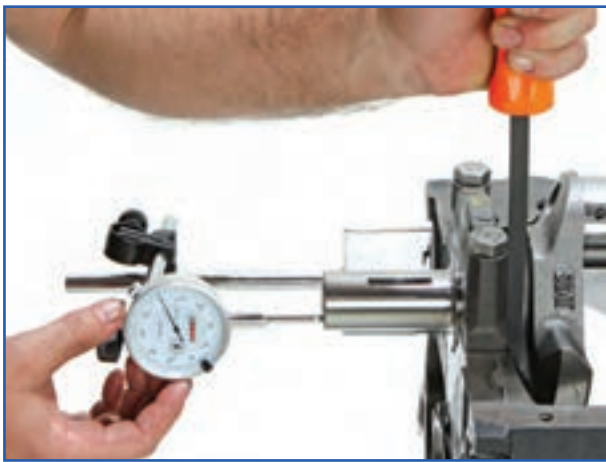
شکل ۱۷۹-۴- اندازه‌گیری لقی طولی میل‌لنگ با ساعت اندازه‌گیری
