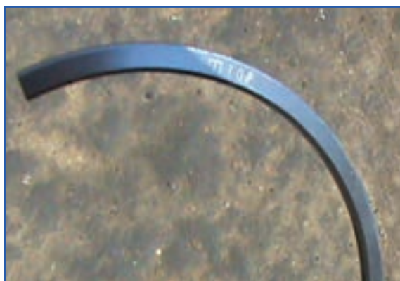
شکل ۴-۱۳۴- علامت TOP روی رینگ
