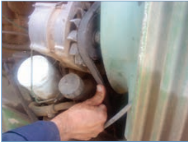
شکل ۲۸-۳- اندازه‌گیری کشش تسمه با فشار انگشت
