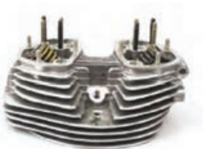
شکل ۳-۲ - سرسیلندر موتور هوا خنک
