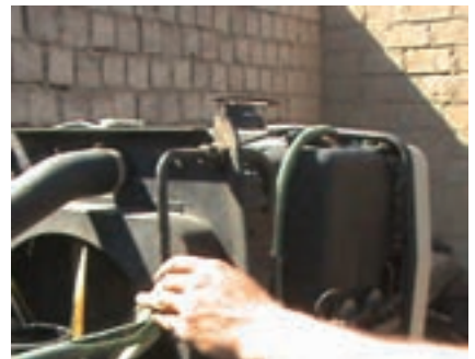
د) باز کردن لوله خنک کن روغن
