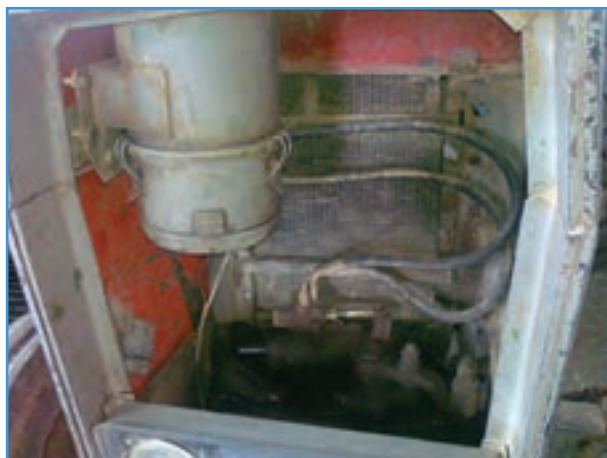
شکل ۱۶-۵- محل قرار گرفتن صافی هوا در تراکتور MF285
