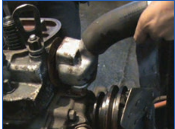
الف) باز کردن محافظه ترموستات تراکتور U650
