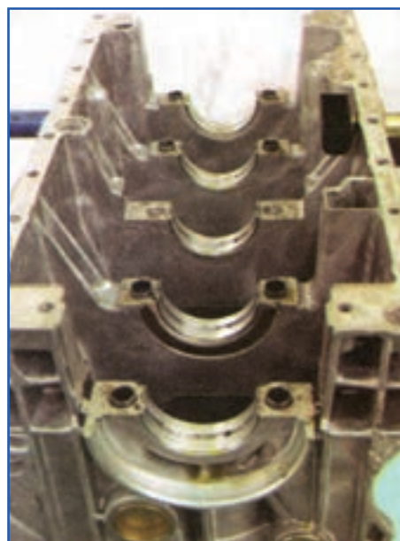
شکل ۱۸۶-۴ یاتاقان‌های ثابت در محل خود روی بدنه سیلندر
