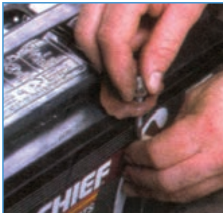
شکل ۹-۶- باز کردن بست نگهدارنده باتری
