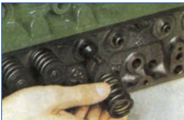
شکل ۴-۲۱- نحوه برداشتن فنر سوپاپ
