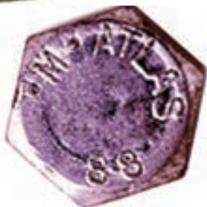
شکل ۱۵-۳ اعداد حک شده روی سر پیچ
