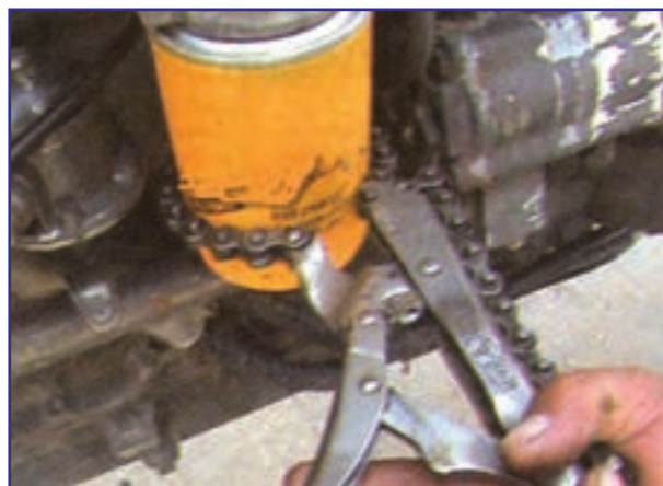
شکل ۱۶-۷- باز کردن صافی روغن با آچار مخصوص
