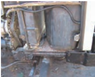
و) باز کردن بست نگهدارنده باک
