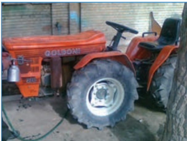
شکل ۱-۴- شستشوی موتور تراکتور با پیستوله شستشو
