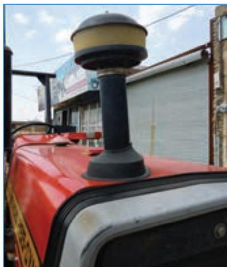
شکل ۲۵-۲- پیش صافی تراکتور MF285
