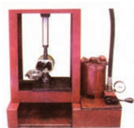
شکل ۱۰۸-۴- خارج کردن انگشتی با پرس هیدرولیک
