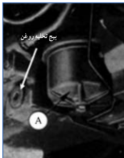
شکل ۵۷-۷ صافی روغن هیدرولیک در تراکتور جان‌دیر
