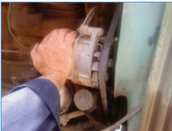
شکل ۳۰-۶ فشار دادن آلترناتور به عقب
