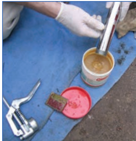
شکل ۴۸-۷- مراحل پر کردن گریس پمپ دستی
