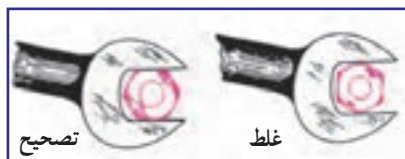
شکل ۲۹-۳- طرز درگیر کردن آچار تخت با مهره
