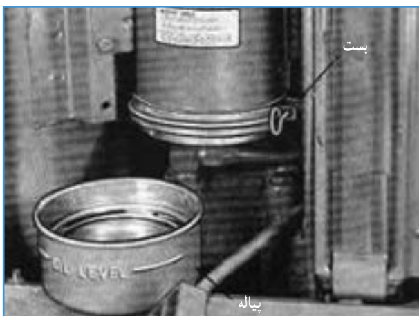
شکل ۱۷-۵- باز کردن پیاله زیر صافی
