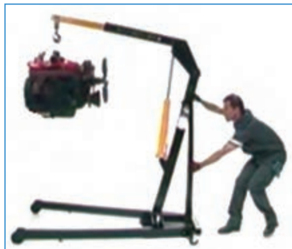
شکل ۱۸-۴ کاربرد از جرثقیل متحرک دستی
