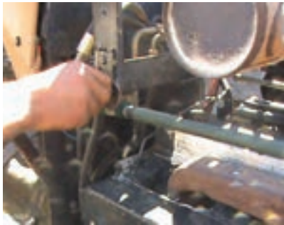
ج) باز کردن شاسی نگهدارنده رادیاتور
