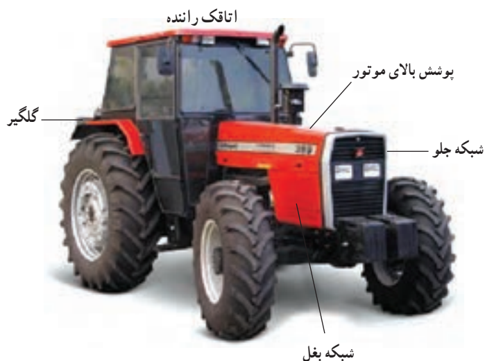
شکل ۲-۲- بدنه و پوشش‌های تراکتور مسی فرگوسن (MF399)
