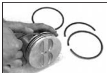
(ج) تمیز کردن شیپار رینگ‌ها با رینگ شکسته
