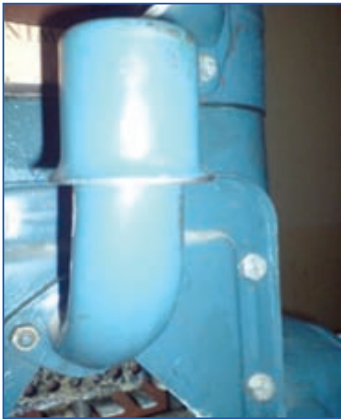
شکل ۲۹-۷- هواکش روغن U650M
