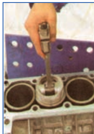
شکل ۱۲۷-۴- طرز قرار دادن رینگ داخل سیلندر
