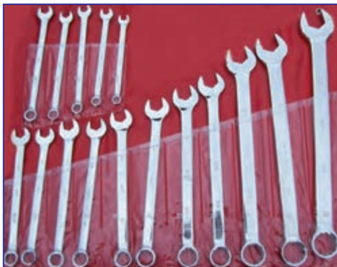
شکل ۳۳-۳- یک سری آچار یک سر رینگی
