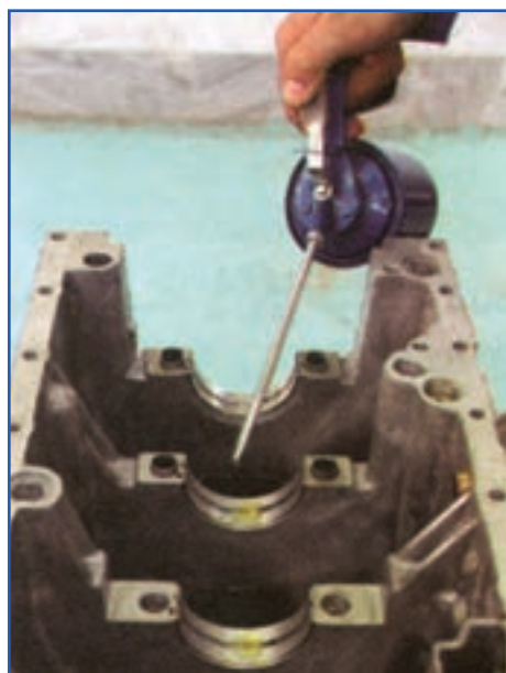
شکل ۱۸۷-۴ روغن کاری یاتاقان‌های ثابت
