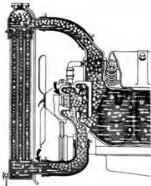
شکل ۳۶-۳- جوش آوردن آب موتور
