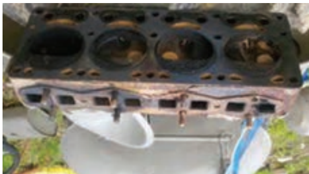
شکل ۲۰۹-۴- رسوبات کربن سطح سرسیلندر
