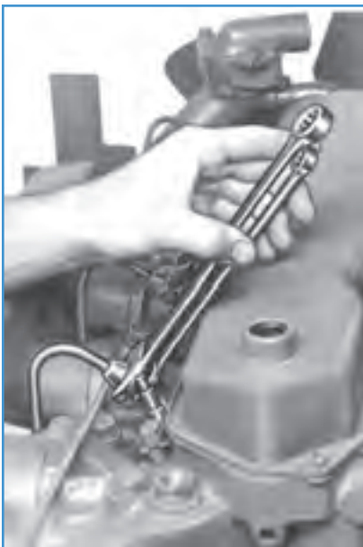
شکل ۲۲-۴- باز کردن لوله‌های فشارقوی انژکتورها
