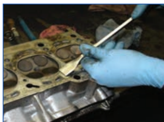
شکل ۴۲-۴- واشر سرسیلندر چسبیده به سیلندر
