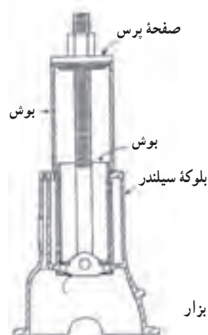
شکل ۱۴۳-۴- نحوه پیاده کردن بوش سیلندر
