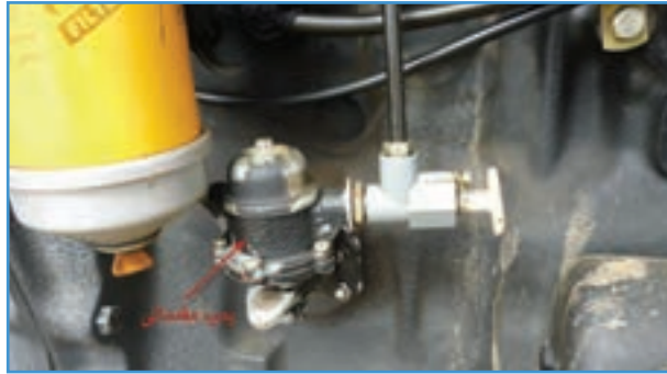
شکل ۲۹-۲- پمپ مقدماتی تراکتور MF285
