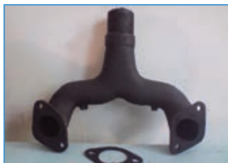
شکل ۲۱-۵- مانیفولد دود تراکتور U650
