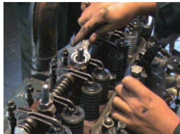
الف) باز کردن پایه محور اسبک تراکتور U 650
