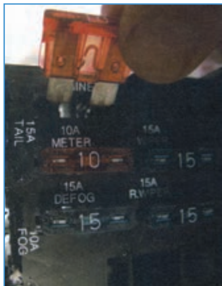
شکل ۶۹-۶- جازدن فیوز در محل آن
