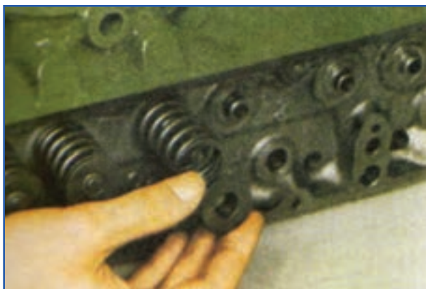
شکل ۴-۲۰- نحوه برداشتن بشقابک فنر سوپاپ
