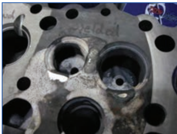
شکل ۲۶-۴- ترمیم ترک سرسیلندر با جوشکاری
