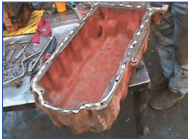
شکل ۲۵-۷- کارترو تراکتور MF285
