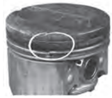
شکل ۴-۹۹- شکستن رینگ و تخریب جای رینگ
