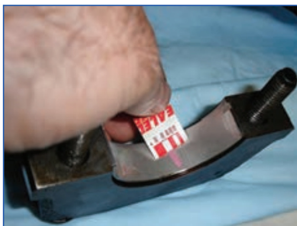
شکل ۱۷۷-۴- وضعیت پلاستی گیج قبل و بعد از آزمایش لقی میل‌لنگ
