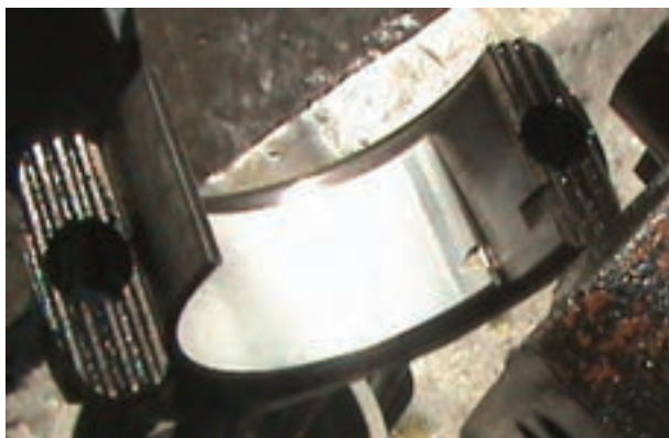
شکل ۸۶-۴- جا زدن زبانه یاتاقان در شیار کپه یاتاقان
