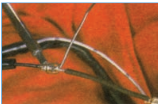
شکل ۶-۶۴- نحوه لحیم کاری سیم‌ها
