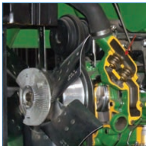
شکل ۲۴-۳ - طرز صحیح قرار گرفتن ترموستات
