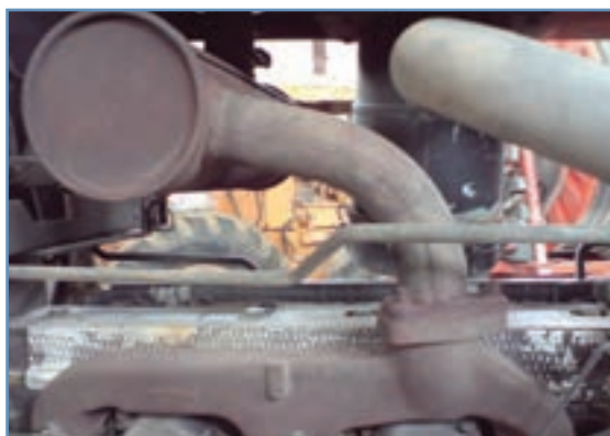
شکل ۳۰-۵- محل اتصال منبع اگزوز به مانیفولد
