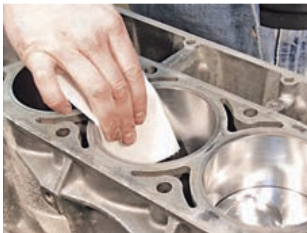
شکل ۲۰۸-۴- تمیز کردن داخل سیلندر
