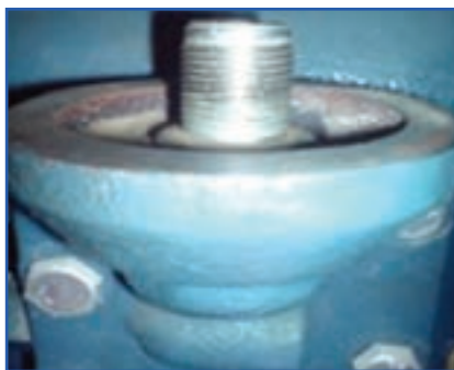
شکل ۱۷-۷- پایه صافی روغن تراکتور U650M
