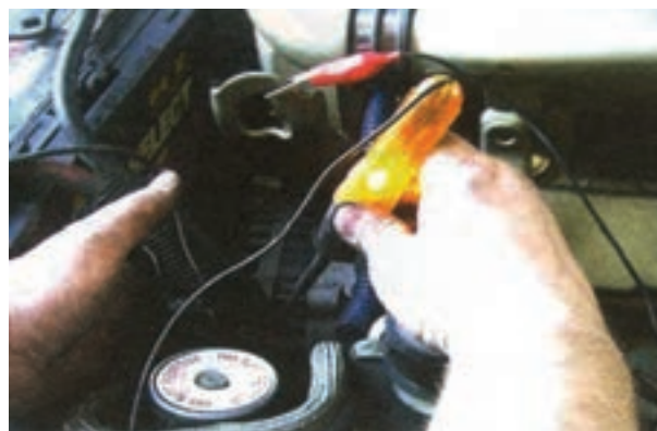
شکل ۷۷-۶- اتصال لامپ آزمایش به مدار
