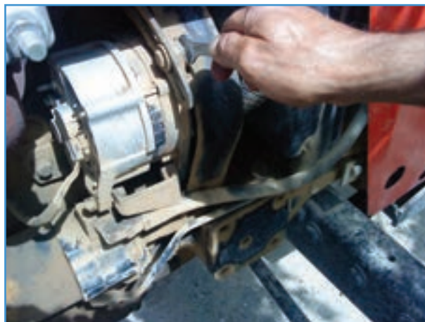
شکل ۲۹-۶ شل کردن پیچ و مهره تنظیم
