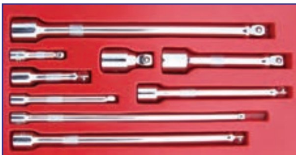
شکل ۴۷-۳- انواع رابط بکس
