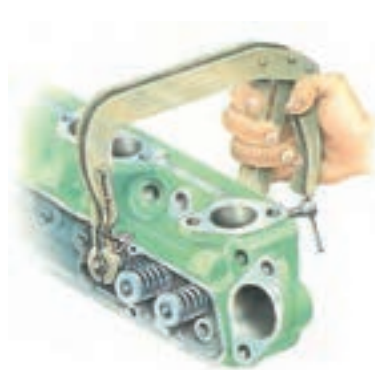
شکل ۴-۱۷- نحوه قرار دادن سوپاپ باز کن روی سوپاپ‌ها
