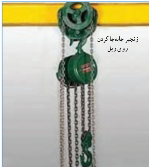
شکل ۲۰-۴- اتصال جرثقیل سقفی به ریل
