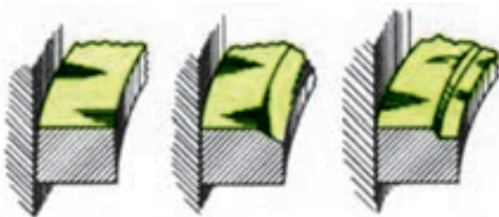
شکل ۴-۱۳۲- فرم خاص در لبه داخلی رینگ
