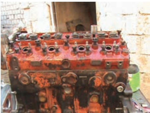
ب) پیچ‌های سرسیلندر باز شده تراکتور MF285
