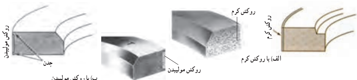
شکل ۲۴-۲- مقطع رینگ‌های تراکم روکش‌دار
