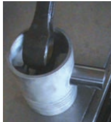
شکل ۱۲۲-۴ اتصال شاتون به پیستون و جازدن انگشتی
