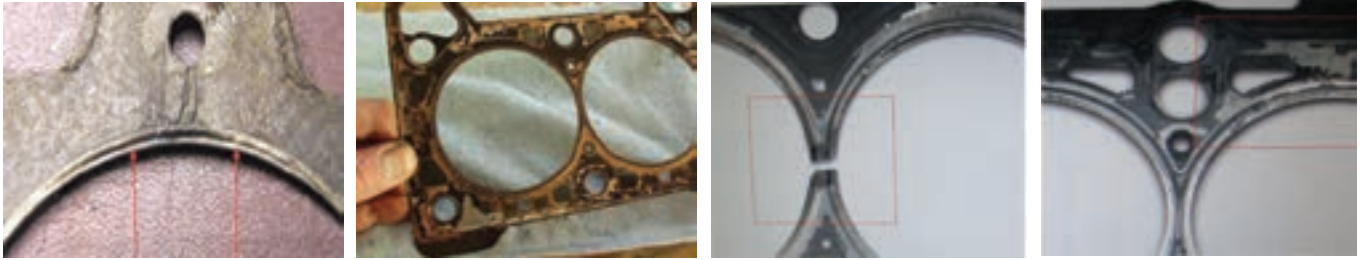
شکل ۵۰-۴- نواحی سوخته شده واشر سیلندر
