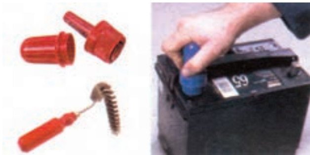
شکل ۲۳-۶- تمیز کردن قطب‌های باتری با ابزار مخصوص
