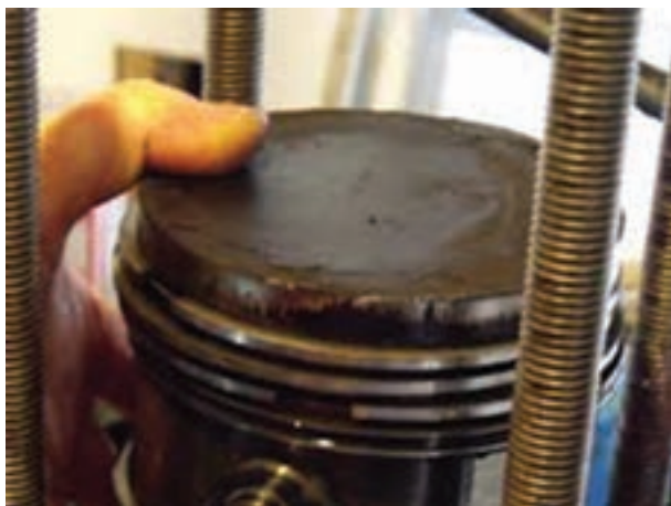
شکل ۲۰۷-۴- رسوبات کربن روی سطح پیستون
