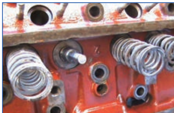
شکل ۴-۲۱- نحوه برداشتن فنر سوپاپ
