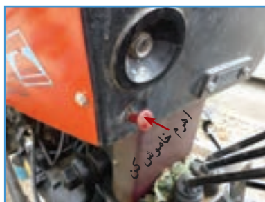
شکل ۱۳-۲ - اهرم خاموش کن تراکتور MF286
