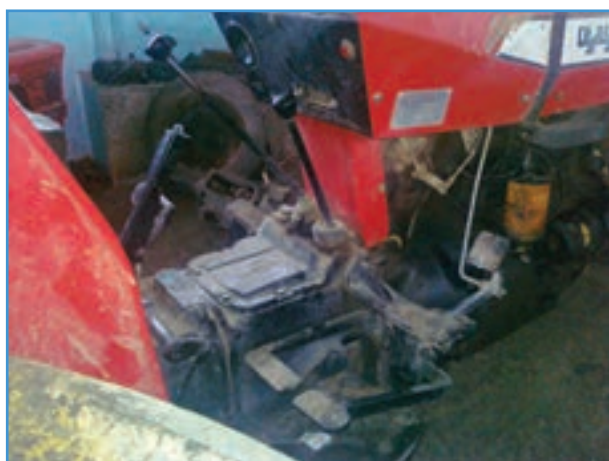
شکل ۲۱-۲- اهرم‌های تعویض دنده و دنده کمک
