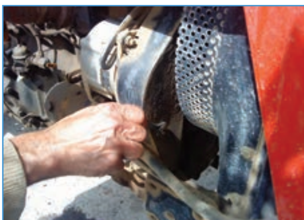
شکل ۳۲-۶ باز کردن روکش محافظ تسمه
