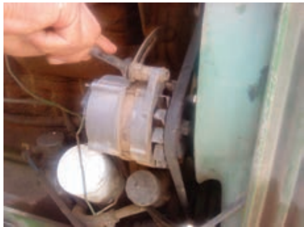
شکل ۳۸-۶ سفت کردن پیچ تنظیم آلترناتور
