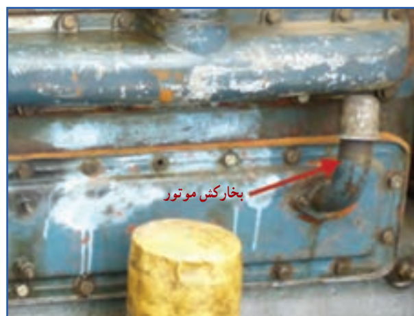
شکل ۲۶-۷- تهویه محفظه کارترو تراکتور U650M
