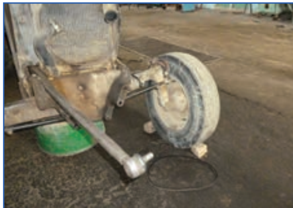
شکل ۱۹-۳- قسمت جلوی تراکتور جدا شده از موتور
