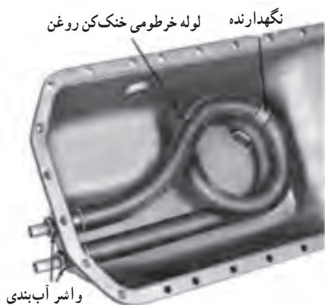
شکل ۳۳-۷- لوله ماریچ آب در کارتر تراکتور جاندیر
