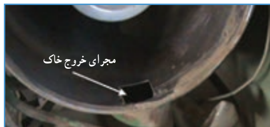
شکل ۱۱-۵- محل خاکدان در تراکتور جاندر
