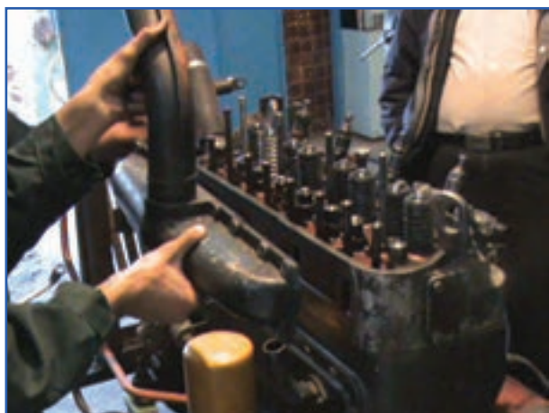
شکل ۴-۴- باز کردن مانیفولد هوا
