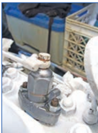
شکل ۵۴-۴- مراحل بستن انژکتور
