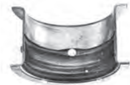
شکل ۱۶۵-۴ خط به دلیل نفوذ ذرات ریز و درشت بین میل‌لنگ و یاتاقان
