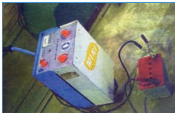
شکل ۱۸-۶ اتصال کابل‌های شارژر به باتری
