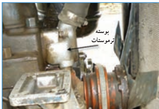
شکل ۳۷-۲ پوسته ترموستات تراکتور U650
