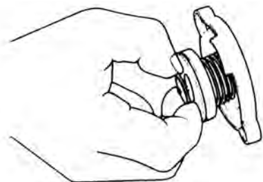
شکل ۱۷-۳- آزمون سوپاپ مکش در رادیاتور
