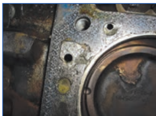
شکل ۴۲-۴- واشر سرسیلندر چسبیده به سیلندر
