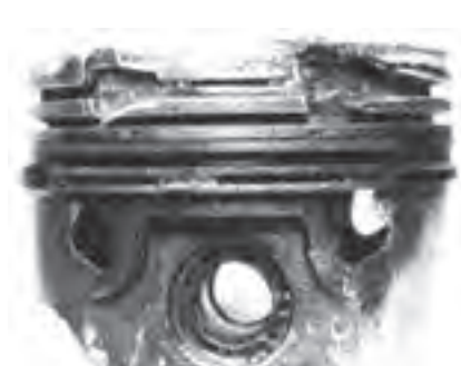
شکل ۴-۱۰۰- تخریب شدید جای رینگ
