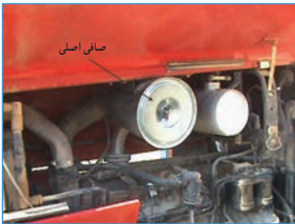
شکل ۵-۶ - محل قرار گرفتن صافی خشک در تراکتور MF399
