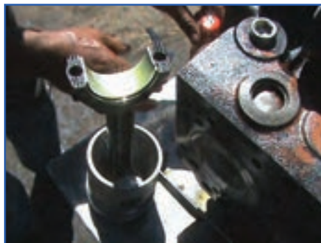
شکل ۱۹۲-۴- روغن‌کاری رینگ‌ها، پیستون و یاتاقان
