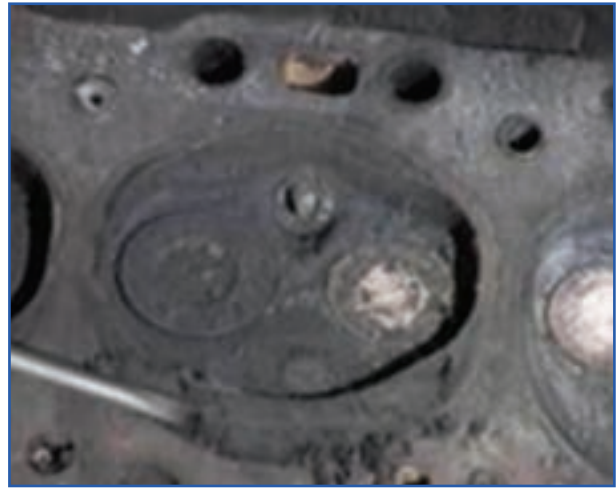
الف) کربن گرفتن سرسیلندر
