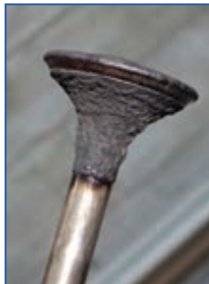
شکل ۴۵-۴- کربن گرفتن بشقابک سوپاپ
