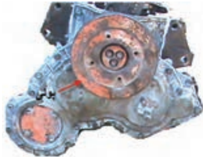
شکل ۴-۶۴- پولی نصب‌شده روی میل‌لنگ
