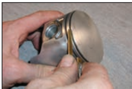
(د) تمیز کردن شیپار با ابزار برنجی
