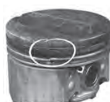
شکل ۴-۹۹- شکستن رینگ و تخریب جای رینگ
