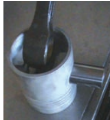
شکل ۱۲۲-۴ اتصال شاتون به پیستون و جازدن انگشتی
