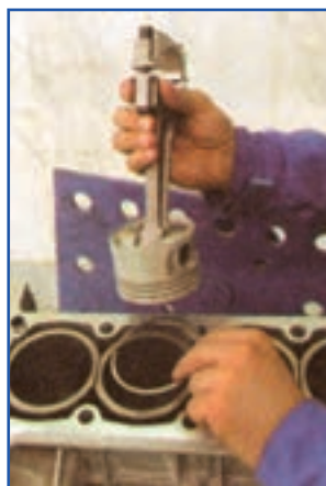
شکل ۱۲۷-۴- طرز قرار دادن رینگ داخل سیلندر
