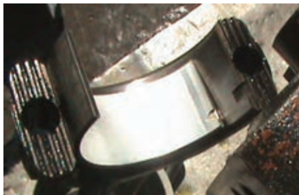
شکل ۸۶-۴- جا زدن زبانه یاتاقان در شیار کپه یاتاقان
