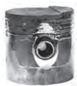
شکل ۴-۱۰۳- سایش غیریکنواخت پیستون
