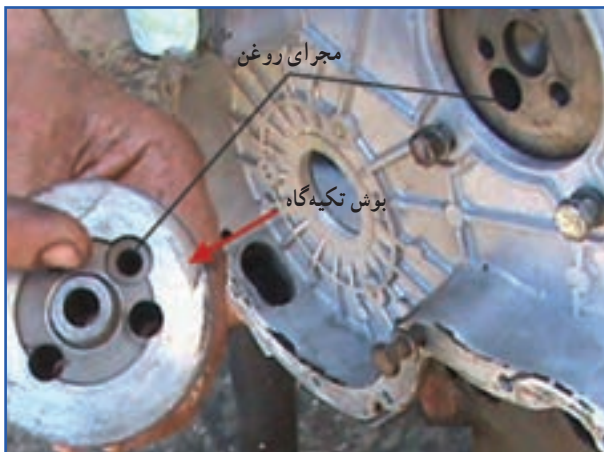
شکل ۶۸-۴ خارج کردن بوش تکیه‌گاه چرخ‌دنده واسط
