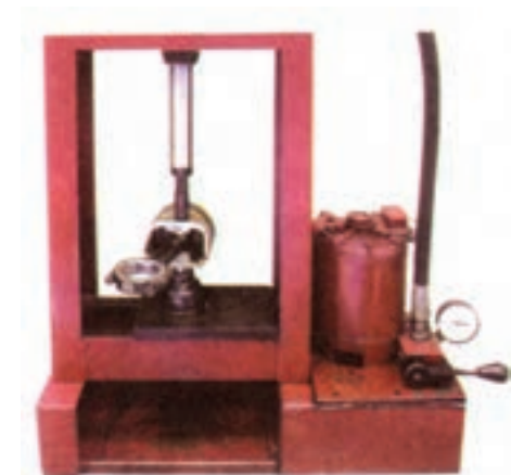
شکل ۱۰۸-۴- خارج کردن انگشتی با پرس هیدرولیک
