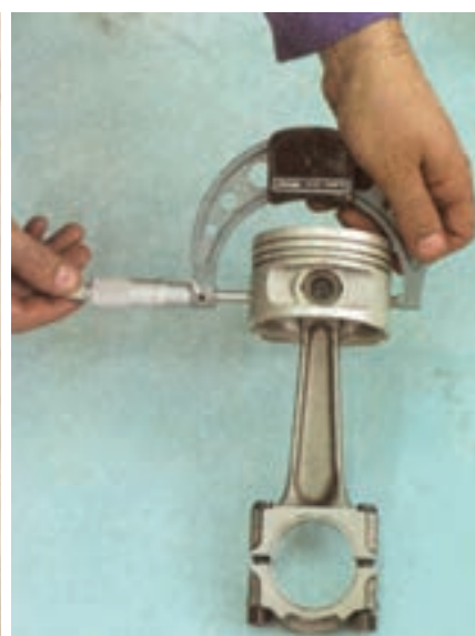
الف) اندازه‌گیری قطر دامن پیستون
