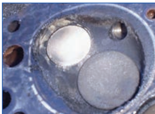
شکل ۴۱-۴- تمیز کردن اتاق احتراق
