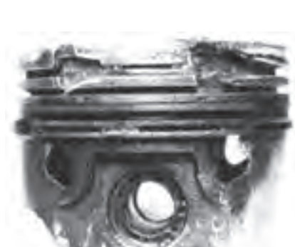
شکل ۴-۱۰۰- تخریب شدید جای رینگ
