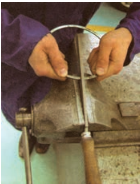
شکل ۱۳۰-۴- ساییدن دهانه رینگ با سوهان
