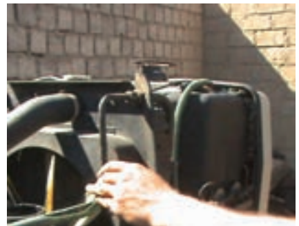
د) باز کردن لوله خنک کن روغن
