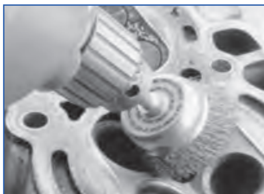
شکل ۴۱-۴- تمیز کردن اتاق احتراق
