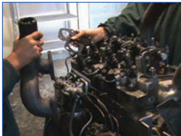
شکل ۴-۴- باز کردن مانیفولد هوا
