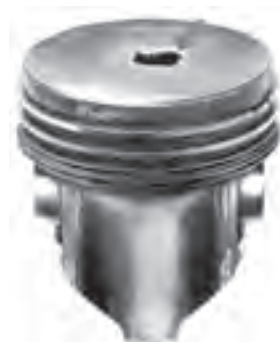
شکل ۴-۱۰۲- سوراخ شدن سر پیستون
