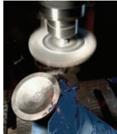
شکل ۴-۴۷ - تمیز کردن کربن سوپاپ با برس سیمی گردان
