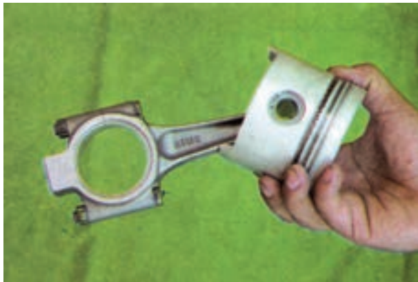
شکل ۱۲۶-۴- طرز آزمایش لقی شاتون روی انگشتی
