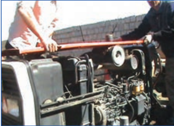
شکل ۱-۴- برداشتن کاپوت از روی موتور
