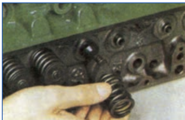
شکل ۴-۲۱- نحوه برداشتن فنر سوپاپ
