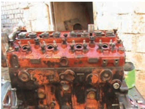
ب) پیچ‌های سرسیلندر باز شده تراکتور MF285
