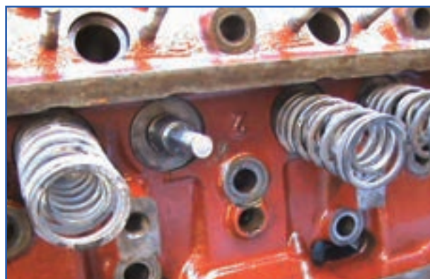
شکل ۴-۲۱- نحوه برداشتن فنر سوپاپ
