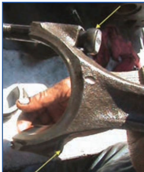
شکل ۸۵-۴- خارج کردن پیچ شاتون
