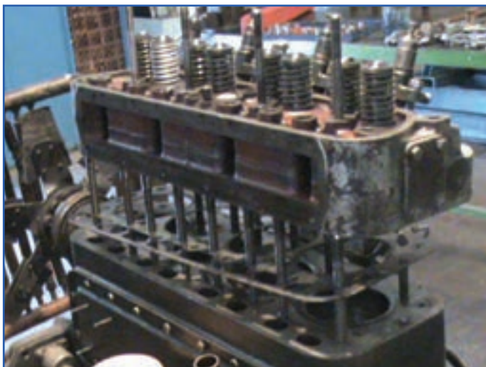
شکل ۲-۵- وضعیت قرار گرفتن واشر سرسیلندر
