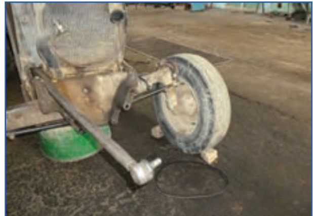
شکل ۱۹-۳- قسمت جلوی تراکتور جدا شده از موتور
