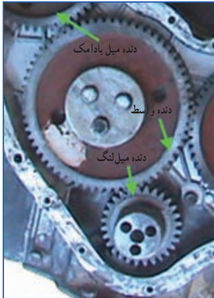
شکل ۱۲-۲- نسبت دنده میل بادامک به میل لنگ
