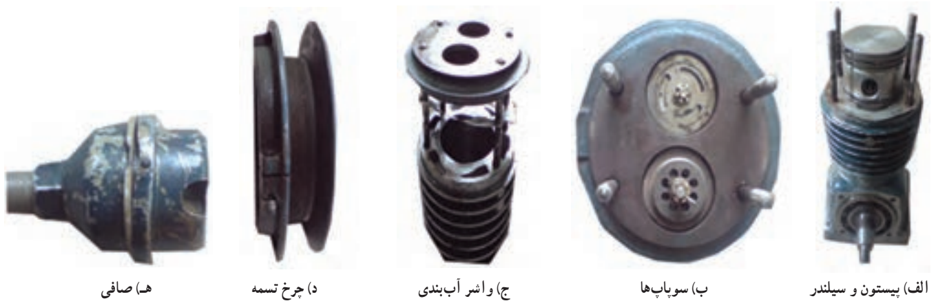
شکل ۳-۸- اجزای کمپرسور باد
