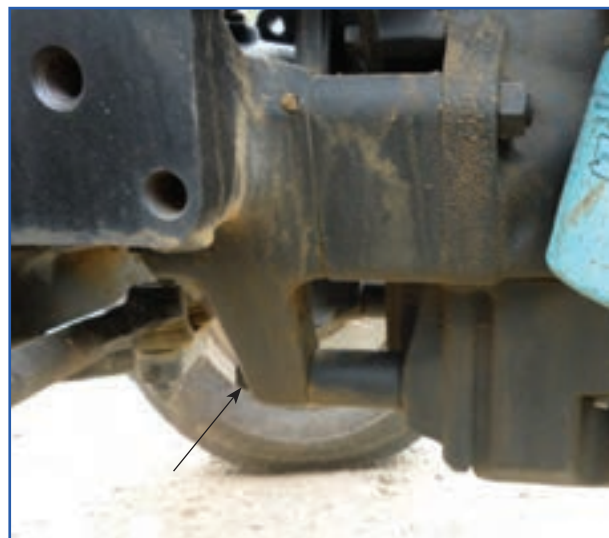
شکل ۱۷-۳- محل پیچ‌های اتصال موتور به جلوی تراکتور
