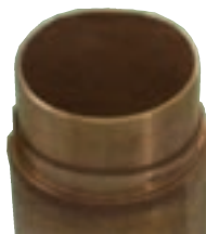
ج) شیار اورینگ روی بوش تر
