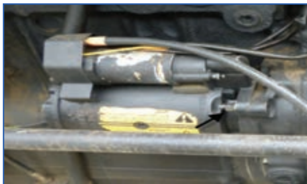
شکل ۳-۸- پیچ های نگهدارنده استارت تر تراکتور MF285
