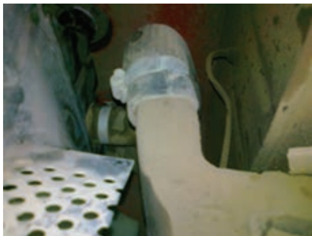
شکل ۱۵-۳- اتصال شیلنگ رادیاتور
