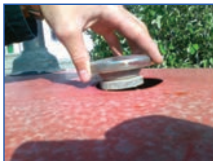
ب) باز کردن در رادیاتور
