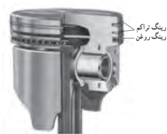
شکل ۲۲-۲- انواع رینگ روی پیستون
