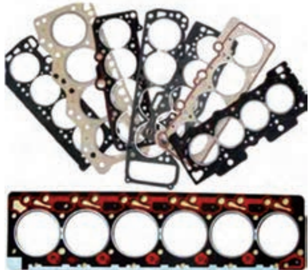
شکل ۶-۲ - چند نوع واشر سرسیلندر
