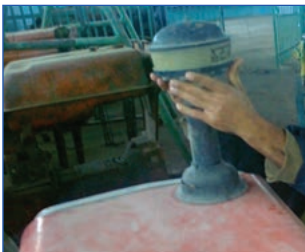
شکل ۲-۳- باز کردن پیش صافی
