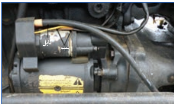
ب) سیم و کابل متصل به استارت تر شکل ۳-۷- سیم های متصل به استارت تر و جلو داشبورد
