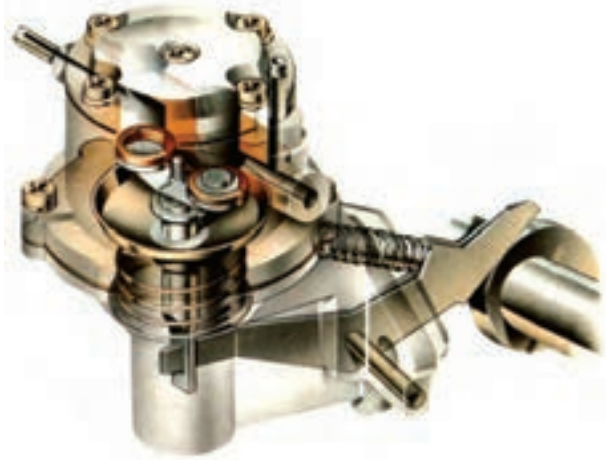
شکل ۷-۴ پمپ مقدماتی دیافراگمی
