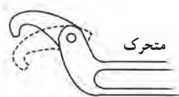
شکل ۵۹-۳- نحوه استفاده از آچار مهره‌ای گرد
