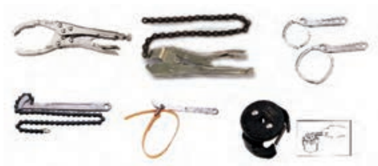
شکل ۶۲-۳- آچار فیلتر بازکن
