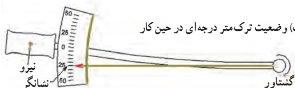
شکل ۳-۵۵- ترک متر درجه‌ای
