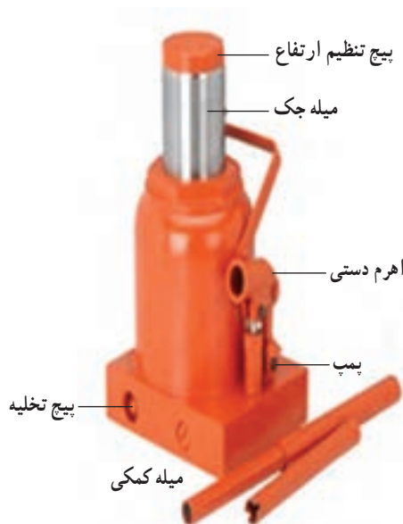
شکل ۹-۴- اجزای جک روغنی
