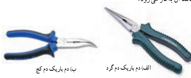
شکل ۶۴-۳ انواع دم باریک
