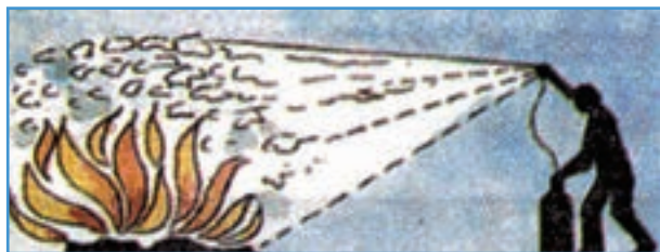
شکل ۱۵-۱- خاموش کردن آتش با کف
