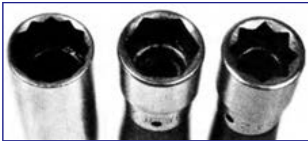
شکل ۳۵-۳- آچار بکس شش، هشت و دوازده گوش
