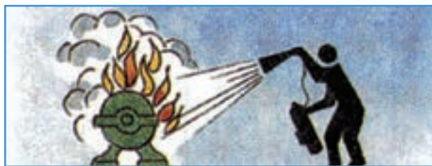
شکل ۱۴-۱- خاموش کردن آتش با دی اکسید کربن
