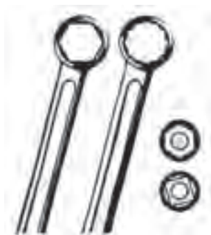
شکل ۳۰-۳- آچار رینگی با سر شش و دوازده گوش
