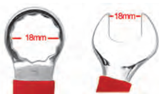
شکل ۳۲-۳- ابعاد آچار یک سر رینگی ۱۸ میلی متری
