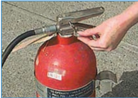
شکل ۱۱-۱- نحوه خارج کردن ضامن کپسول
