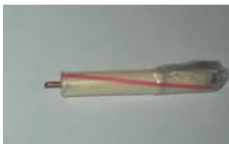
پ) بستن ته مجموعه نی و کابل آنتن به صورت تکیه‌گاه
