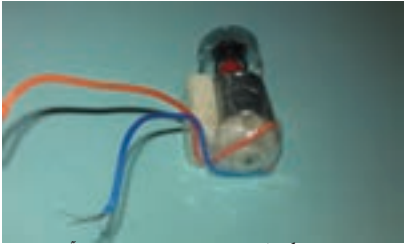
ب - محکم کردن سیم‌ها و عایق‌بندی آن‌ها
