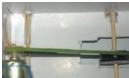
شکل ۳-۵- انتقال حرکت با پولی و تسمه
