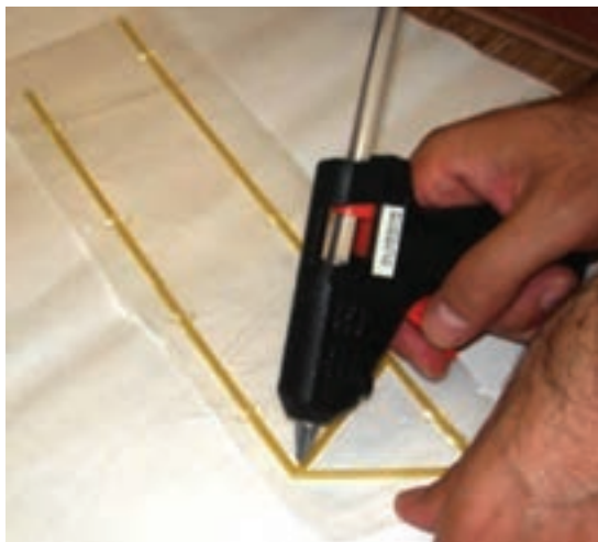
شکل ۳-۲- ساخت قاب جانبی سازه پل ماکارونی
