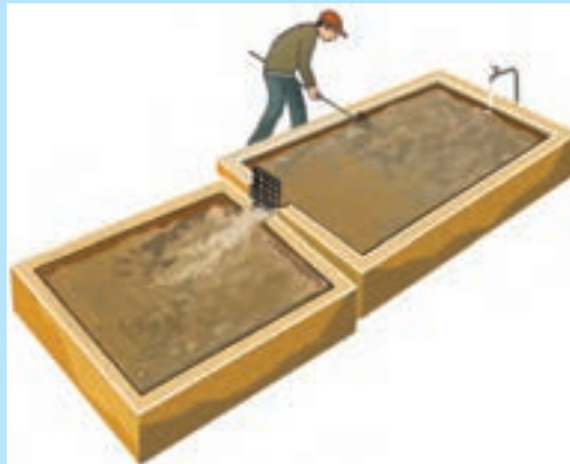
تهیه‌ی آهک شکفته به روش تر (دوغابی)
