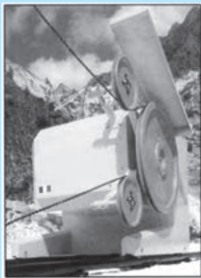
دستگاه برش سنگ با سیم الماسه
