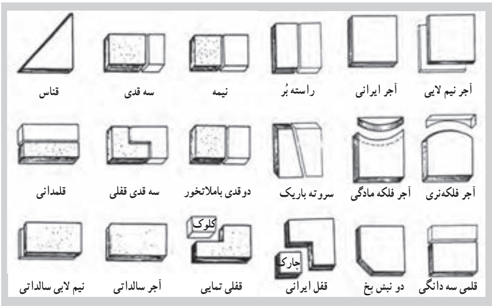
۱۳-۶- اجزای آجر و انواع تراش‌های روی آن
